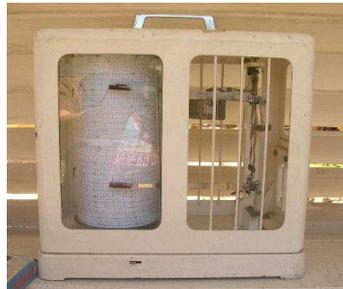
**Figura 1.5 Termógrafo e Higrógrafo**
