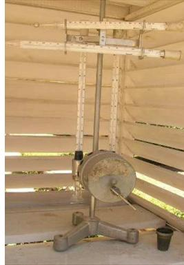
**Figura 1.4 Psicrómetro**
