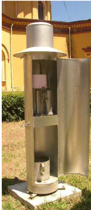
**Figura 1.3 Pluviómetro**
