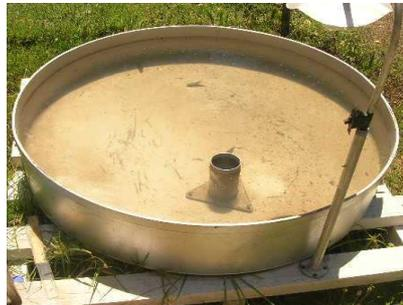
**Figura 1.2 Evaporímetro**
