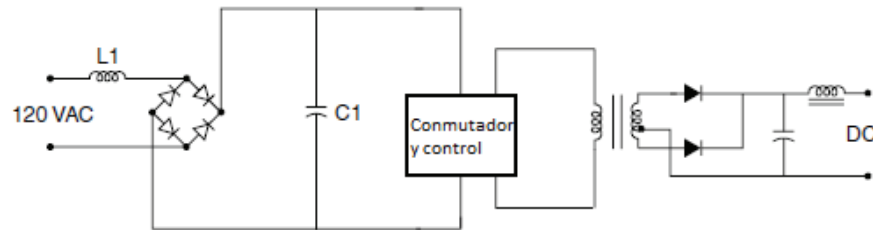
Figura 2.11 Esquema de fuente conmutada en la actualidad
