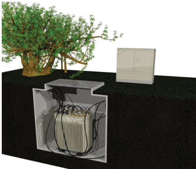
Figura 2.10 Ubicación de transformador sumergible en cámara subterránea
