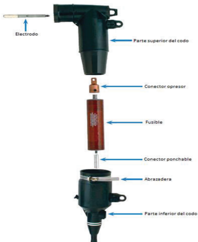
Figura 2.26 Partes de conector tipo codo Portafusible
