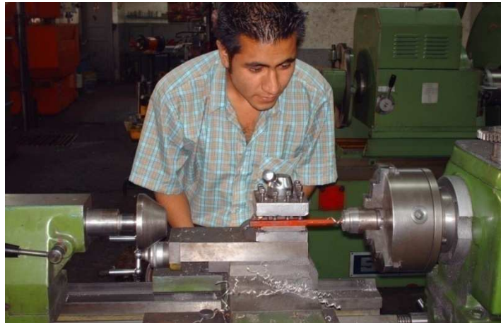
Fotografía 5.1 Torneado interior del bocín.
