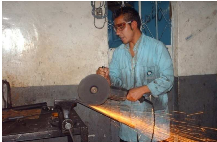
Fotografía 5.2 Corte de los perfiles.
