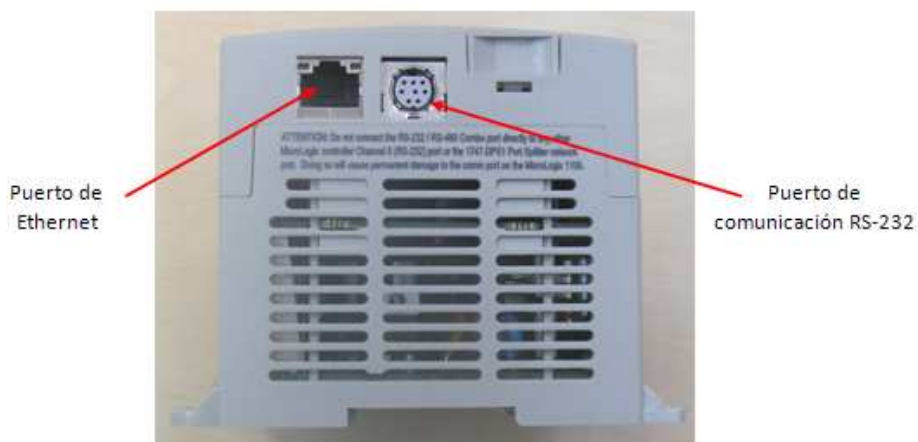
Fig. 4-8. Tipos de comunicación entre el PLC y una computadora u otros dispositivos.
