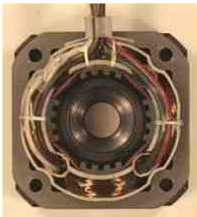
Fig. 26 Imagen de un estator de 4 bobinas
