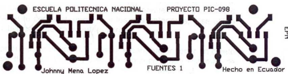
Fig. 49 Circuito impreso de la fuente de alimentación de 5V, 12V y 24V.
