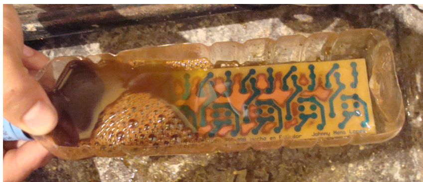
Foto 17 Remoción de cobre en el proceso de elaboración del circuito impreso.
