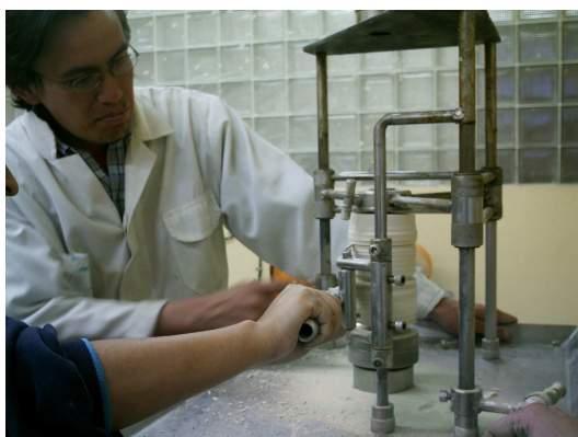
Foto 10 Operación de formado de un aislador en el torno
