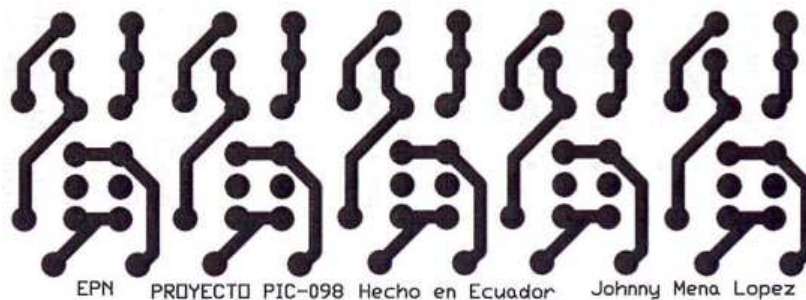
Fig. 51 Circuito impreso de la tarjeta de salida de relés.
