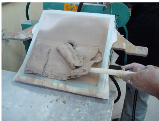
Foto 8 Arcilla adherida al filtro.
