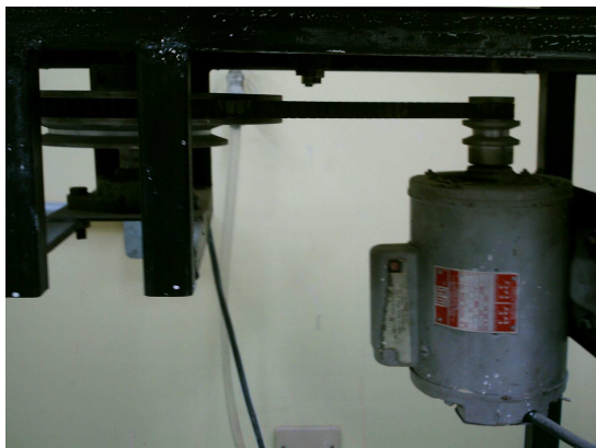
Foto 13 Sistema de transmisión de la rotación del torno actual
