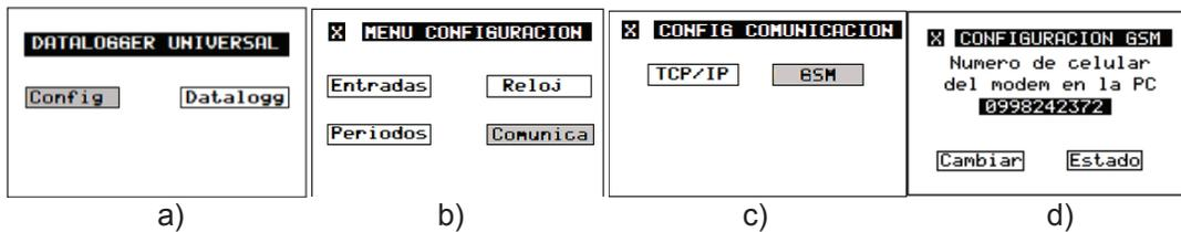
**Figura 4.39** Selecciones para ingresar al menú configuración GSM (módulo GSM)
