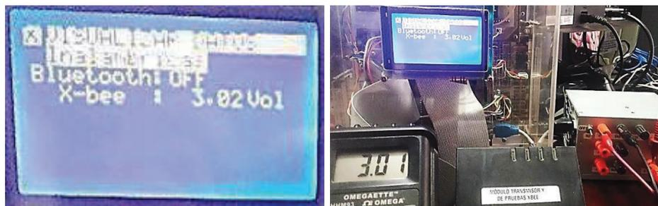
**Figura 4.24** Adquisición de datos por medio inalámbrico usando módulos XBee
