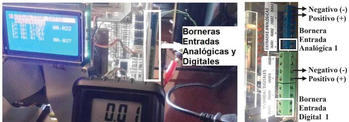
Figura A.12 Borneras para entradas analógicas y digitales
