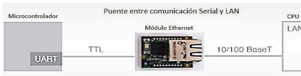
**Figura 2.12** Esquema de operación del módulo Ethernet (Nano Socket LAN)
