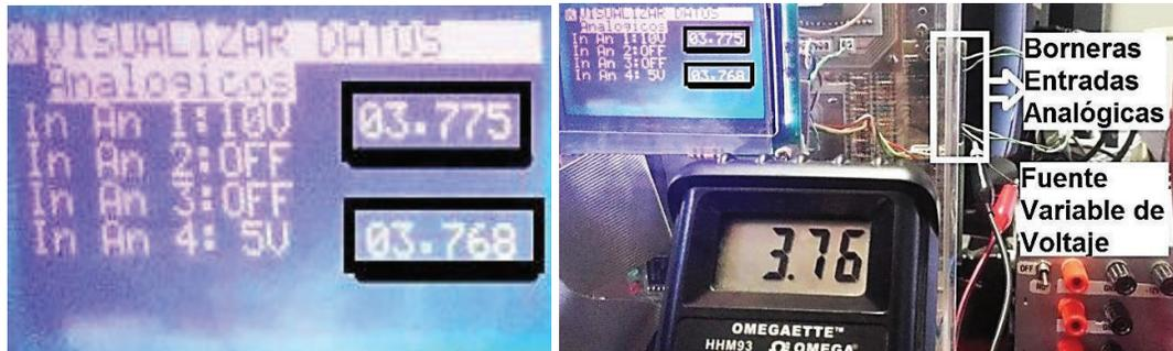
**Figura 4.7** Señal de ingreso dentro de los rangos de operación de las entradas 1 y 4
