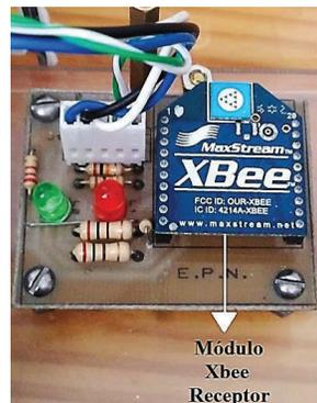
**Figura 4.23** Módulo XBee receptor
