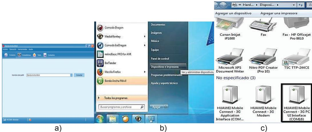
**Figura A.42** Programa el Modulo GSM y proceso para Identificar puerto COM
