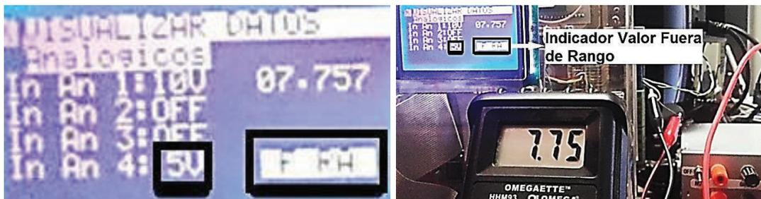
Figura A.24 Valor de señal analógica fuera del rango configurado
