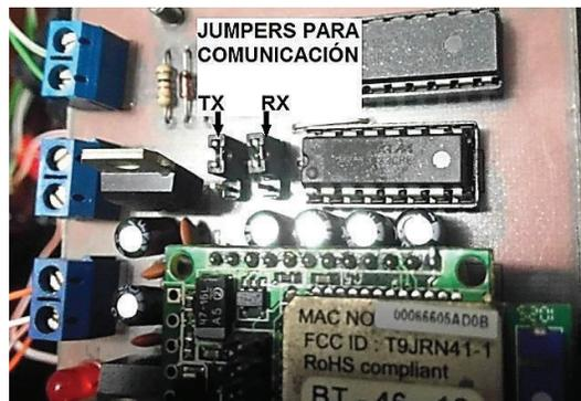
**Figura A.60** Jumpers para comunicación UART del transmisor Bluetooth
