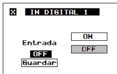
Figura 4.11 Menú configuración de entradas digitales
