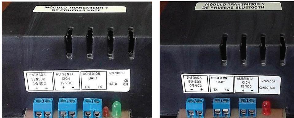
**Figura A.59** Módulos inalámbricos XBee y Bluetooth
