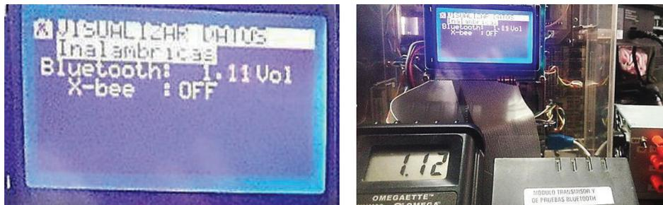
**Figura 4.20** Adquisición de datos por medio inalámbrico usando tecnología Bluetooth
