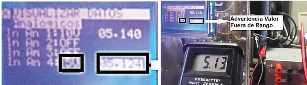
Figura A.23 Señal analógica dentro de los valores de advertencia fuera de rango
