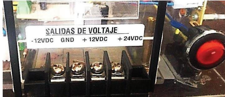
**Figura A.61** Borneras de salida de voltaje o para alimentación de elementos externos
