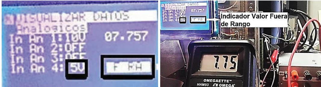
Figura 4.9 Señal de ingreso fuera del rango configurado
