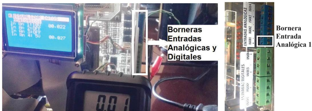
**Figura 4.4** Borneras para entradas analógicas y digitales
