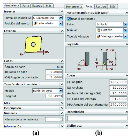
Figura 4.5: Parámetros de (a) inserto y (b) porta inserto modificados para herramienta de refrentado Fuente: (Autor)
