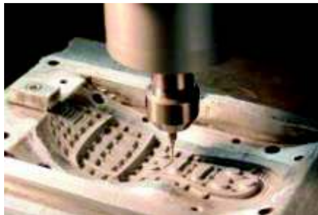
Figura 1.3: Maquinado de una pieza por medio de programación CAM Fuente: (Escuela Técnica Superior de Ingeniería- Bilbao, 2016)
