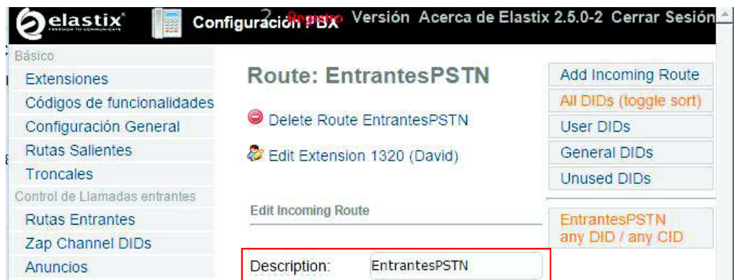
Figura 2.21 Parámetros de configuración de ruta entrante
