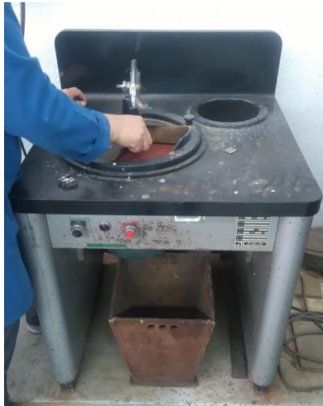
Figura 2.14. Proceso de desbaste grueso en probetas para metalografía (Fuente propia)
