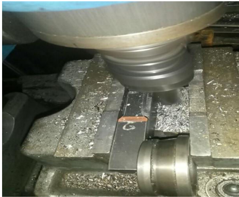
Figura 2.9. Proceso de fresado en probetas de tracción (Fuente propia)
