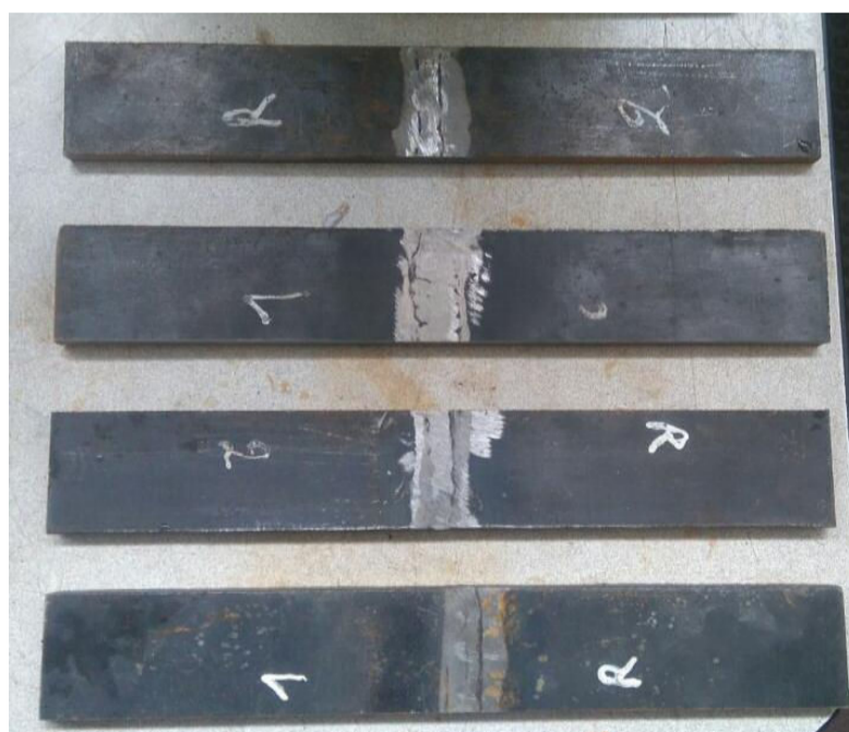
Figura 3.11. Probetas para el ensayo de doblado. (Fuente propia)
