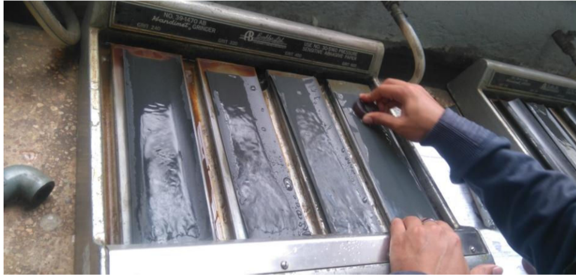
Figura 2.16. Proceso desbaste fino en probetas para metalografía (Fuente propia)
