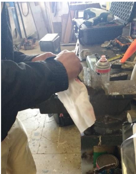
Figura 3.7. Remoci6n de exceso de liquido penetrante en probeta 13 – 14 (Fuente propia)
