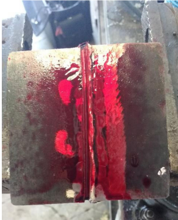
Figura 3.6. Aplicación de líquido penetrante a probeta 13 – 14 (Fuente propia)
