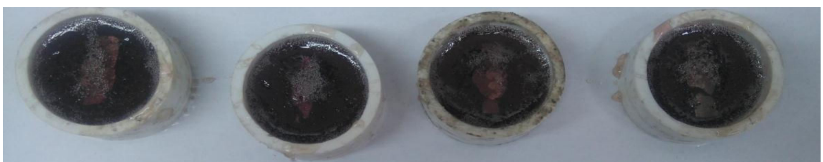
Figura 2.15. Proceso de montaje con resina en probetas para metalografía (Fuente propia)
