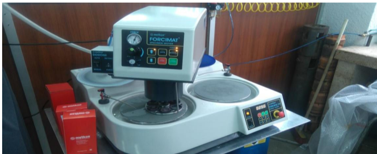
Figura 2.17. Proceso pulido en probetas para metalografía (Fuente propia)
