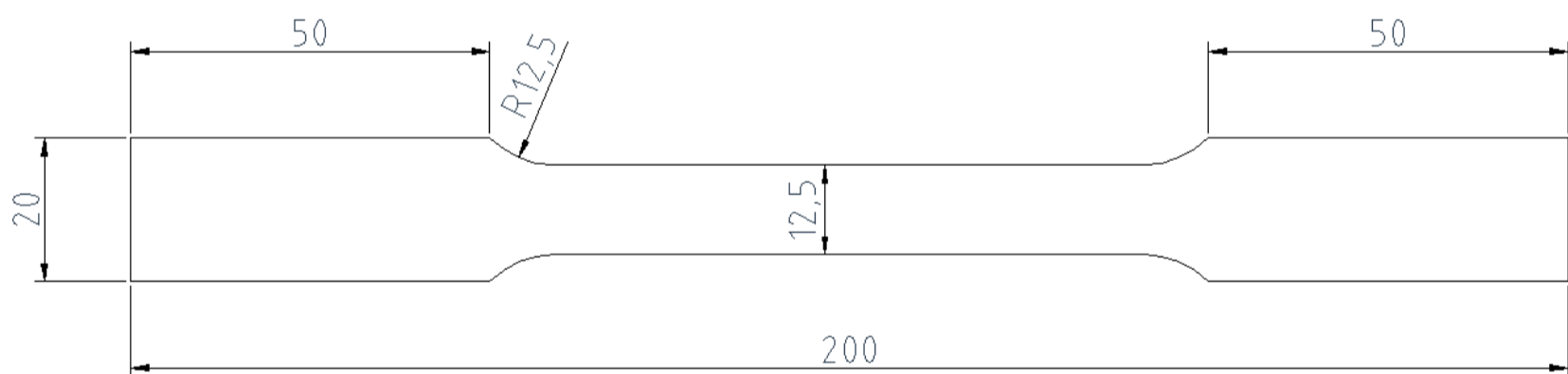
Figura 2.10. Medidas en milímetros de la probeta de tracción (Fuente propia)
