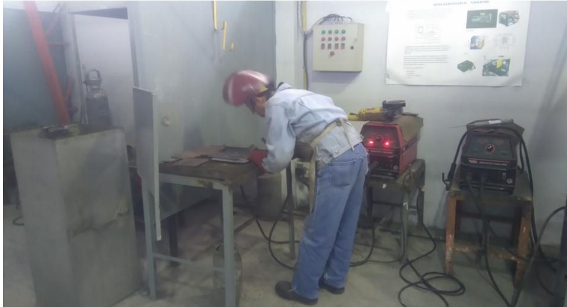
Figura 2.6. Soldadura de las probetas (Fuente propia)
