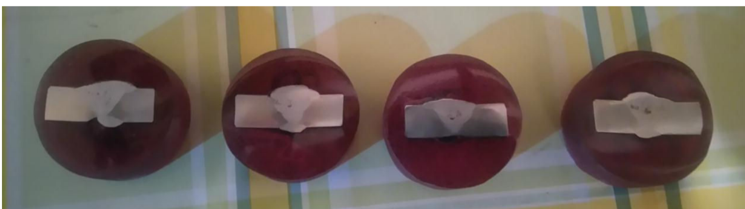
Figura 3.15. Probetas con ataque químico con cloruro férrico. (Fuente propia)
