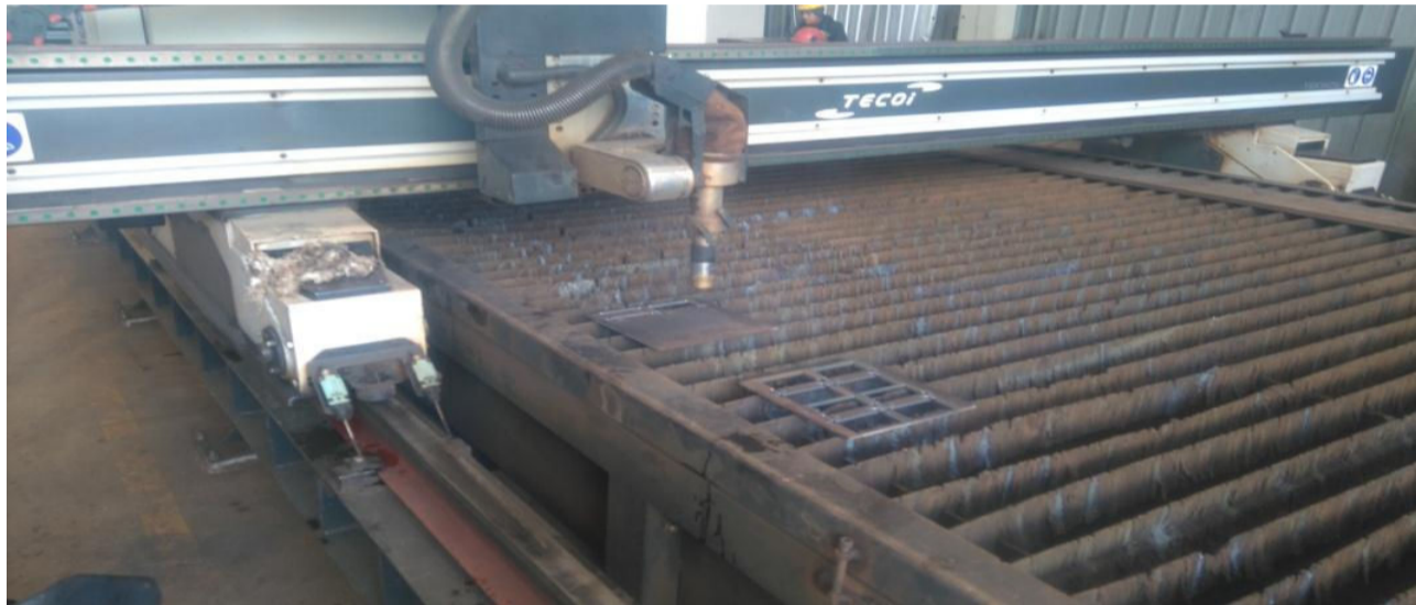
Figura 2.1. Cortadora de plasma TECOi cortando las placas (Fuente propia)
