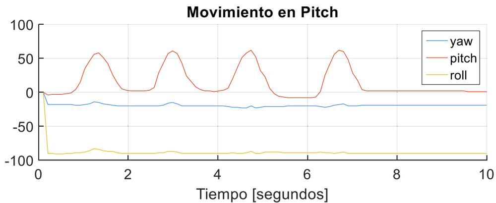
**Figura 2.43** Movimiento del Myo Armband alrededor del ángulo de cabeceo
