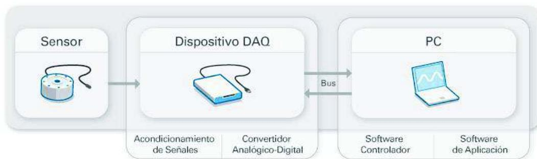
**Figura 1.9** Esquema típico de un proceso de adquisición de señales [22]
