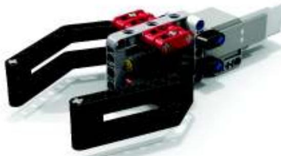
**Figura 2.34** Modelo de pinza robótica [57]
