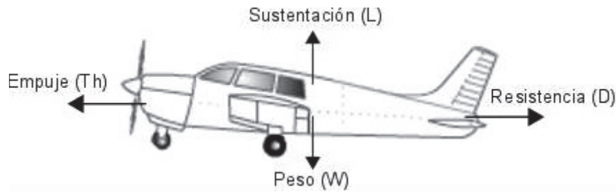
Figura 1.6. Fuerzas aerodinámicas actuantes sobre un avión. (Fuente: Ruiz Lizama & Raffo Lecca, 2005)
