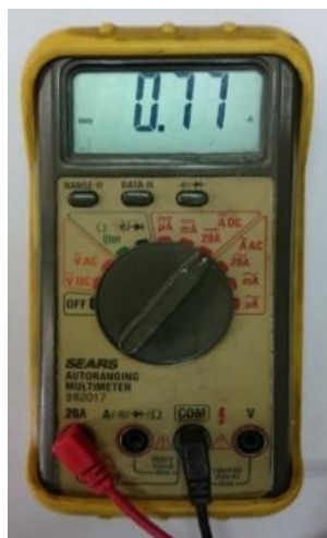
Figura 3.11. Medida de corriente del equipo con amperímetro
