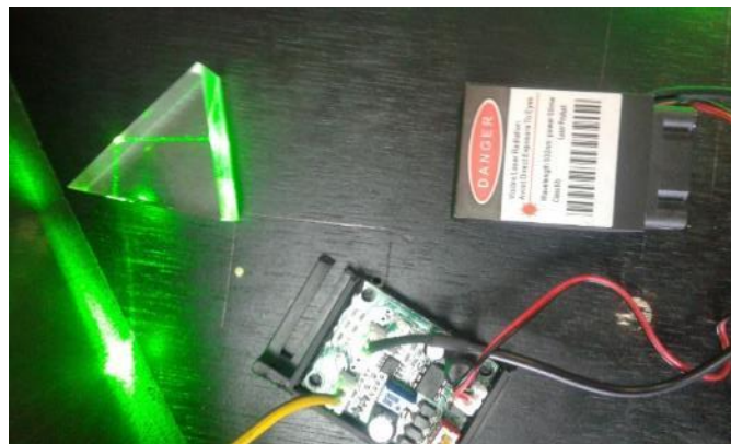
Figura 1.13 Direccionamiento del haz del láser
