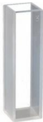
Figura 2.18. Celda de análisis de muestras para espectrofotómetros
