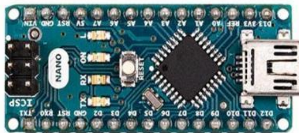
Figura 2.27. Tarjeta de desarrollo Arduino Nano [57]
