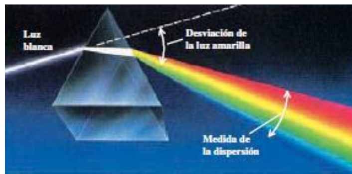
Figura 1. 3. Dispersión de la luz a través de un prisma [10]
