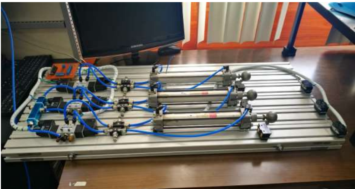
Montaje del circuito electropneumático
