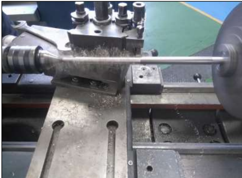
Figura 2.30. Torneado. (Fuente: Propia)
