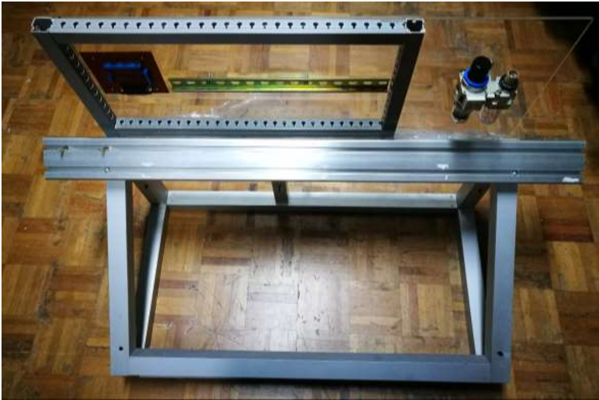
Montaje de la base inclinada
