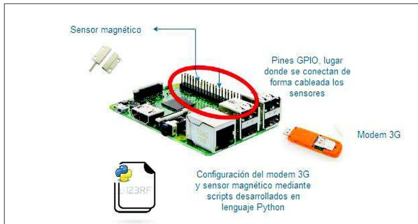
Figura 2.11 Diagrama de la conexión de sensores y modem 3G
