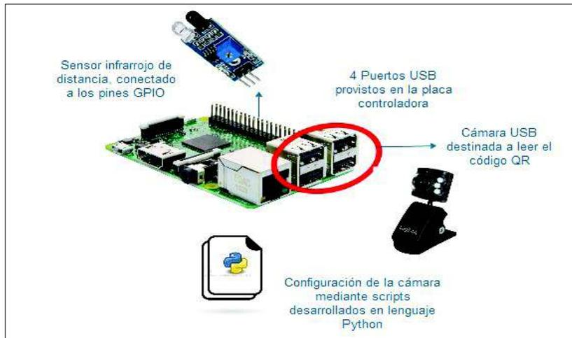
**Figura 2.15** Diagrama de conexión dispositivos del Módulo Lector código QR
