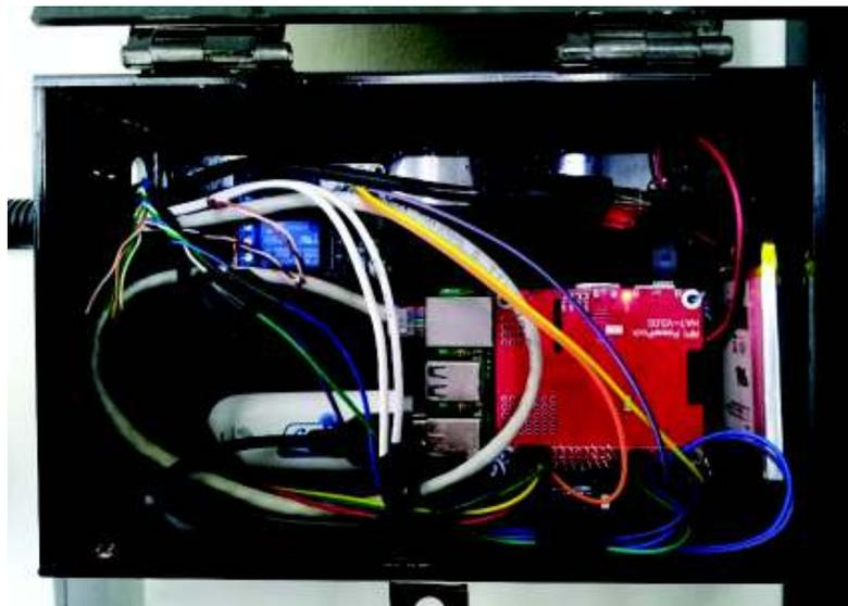
**Figura 2.73** Contenedor de Raspberry Pi y periféricos
