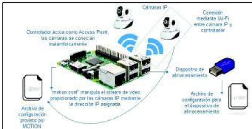
**Figura 2.6** Diagrama Módulo Vigilancia-Alarma
