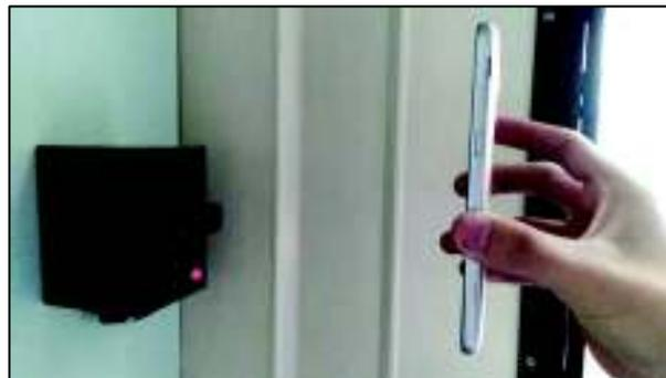
**Figura 3.8** LED indicando mensaje de error o validación fallida
