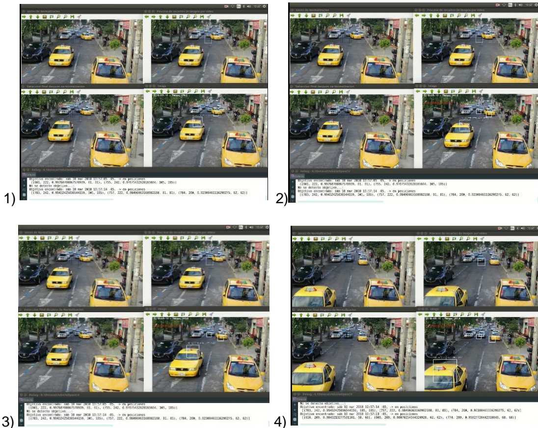
Figura 58. Proceso de captura de infracción de un vehículo.
