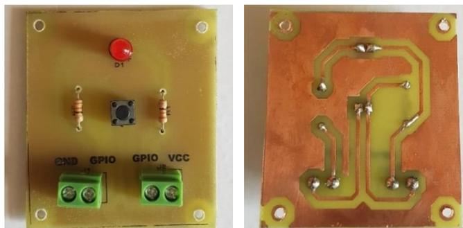
Figura 2.63. Circuito para encender o apagar la Raspberry
