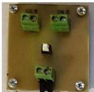
**Figura 2.61.** Circuito para la conexión de los paneles solares.
