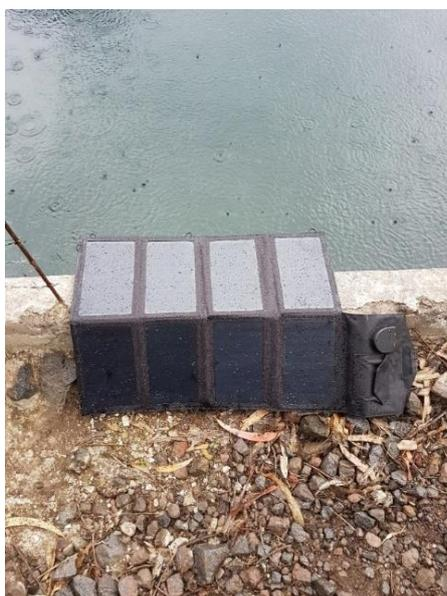
**Figura 3.10.** Paneles solares sin ningún daño después de la lluvia.
