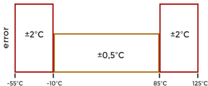
**Figura 2.6.** Error de medición en el sensor DS18B20.
