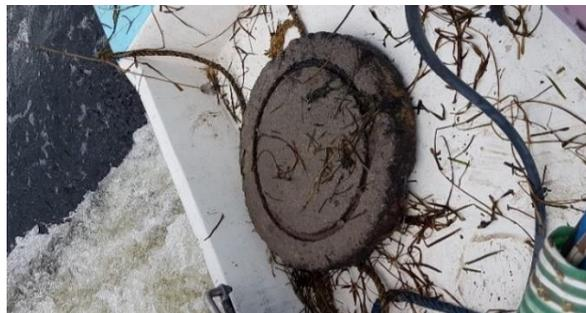
**Figura 3.14.** Pesa para anclar el prototipo.
