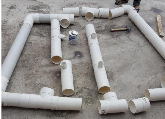
**Figura 2.75.** Implementación de la base de la estructura.
