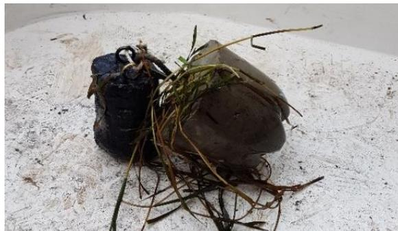
**Figura 3.15.** Pesas para la manguera de sensores.
