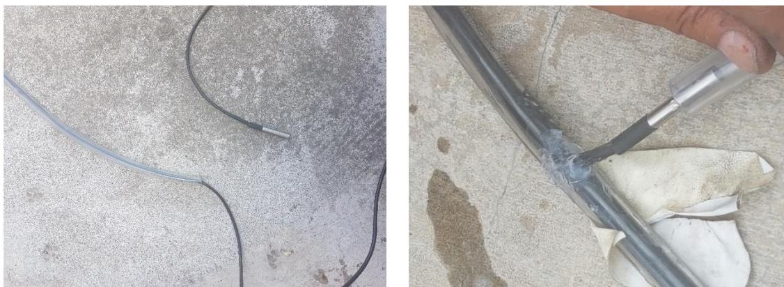
**Figura 2.68.** Instalando los sensores en la manguera.
