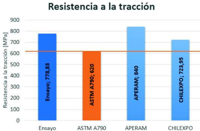
Figura 3.14. Comparación de los resultados vs. la norma ASTM-A790 y fabricantes.
