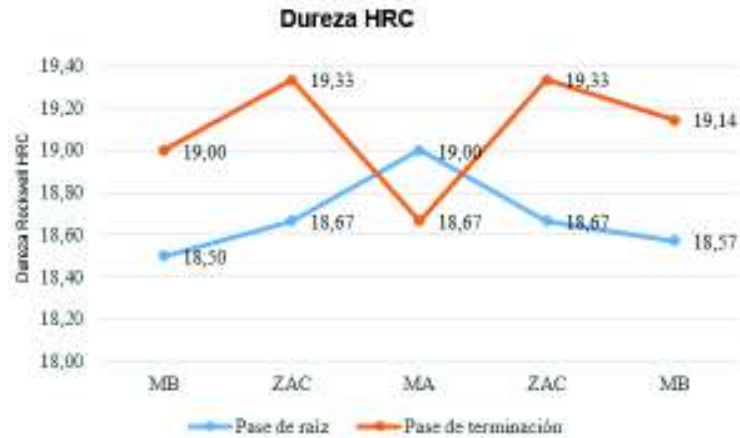
Figura 3. 35. Promedio de las durezas HRC, resultantes de las diferentes zonas.
