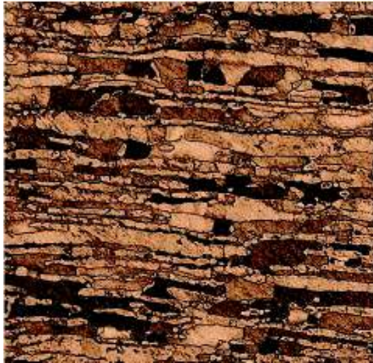
Figura 3.4. Microestructura del material base (500X). (Fuente: Propia, 2018)
