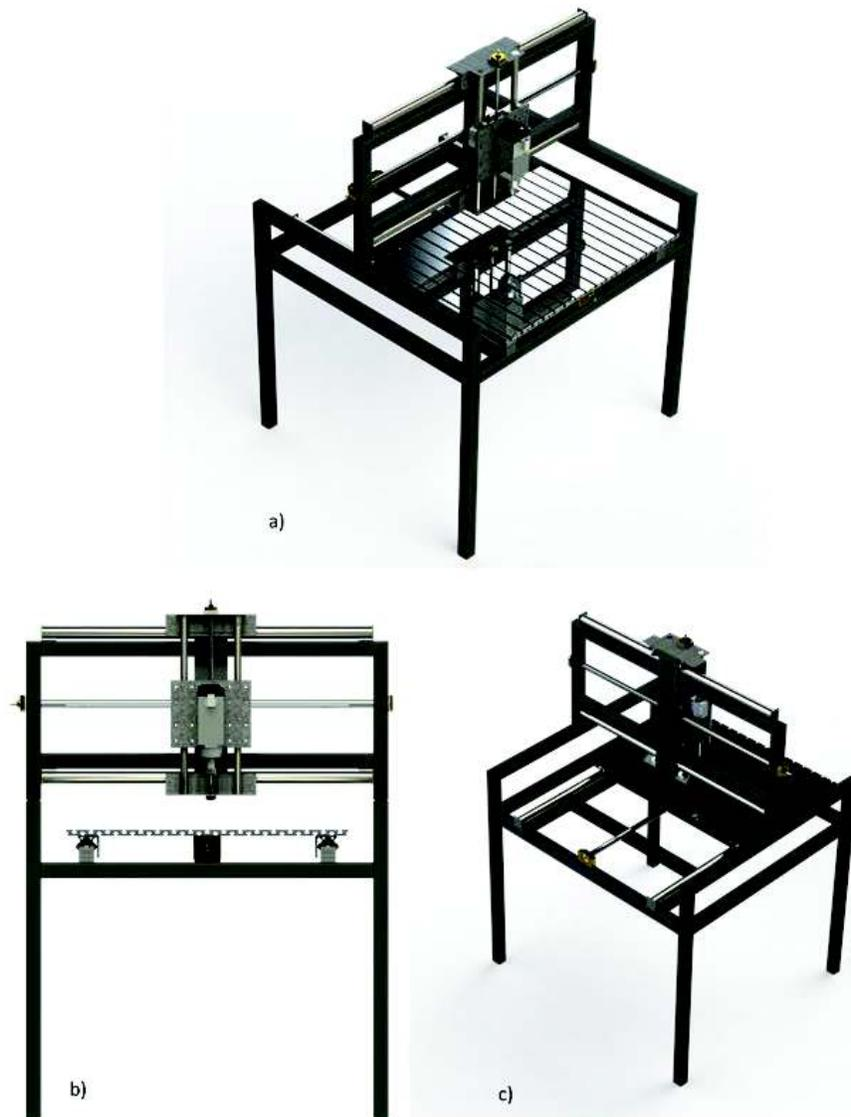
Figura 2.24. Prototipo seleccionado. a) Perspectiva isométrica, b) Vista frontal y c) Perspectiva isométrica trasera
