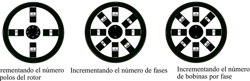
Figura 1.7. Formas constructivas de aumentar resolución de motores paso a paso.
