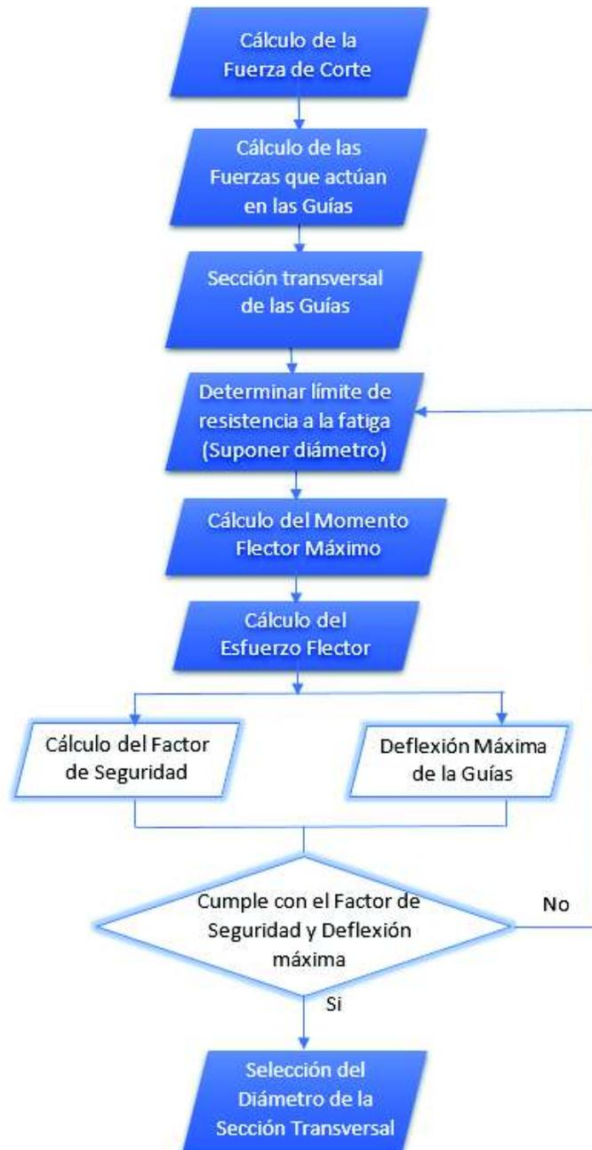
Figura 2.36. Procedimiento de Cálculo de la sección transversal de las Guías (Fuente: Propia)
