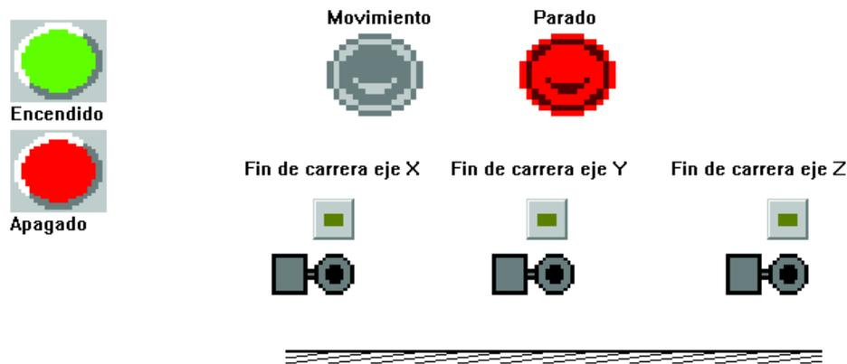
Figura 2.100. Simulación. Señalización y seguridad, pulsador de apagado accionado.
