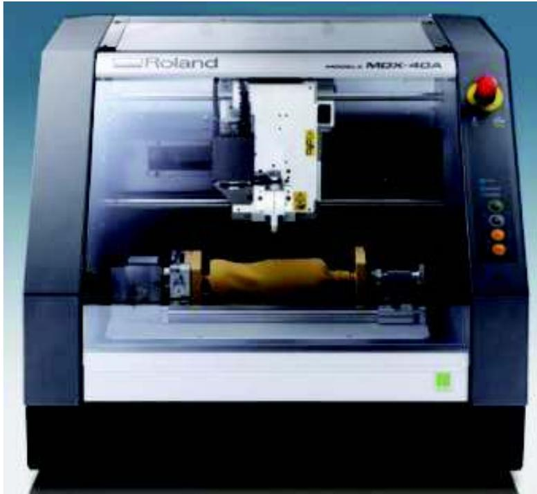
Figura 2.6. Centro de prototipado rápido Roland MDX-40a.
