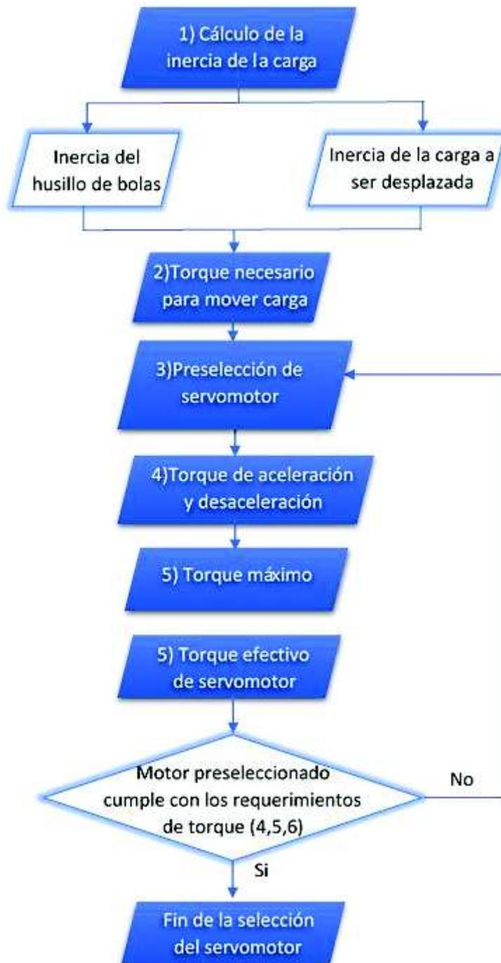
Figura 2.52. Procedimiento de selección de servomotor.
