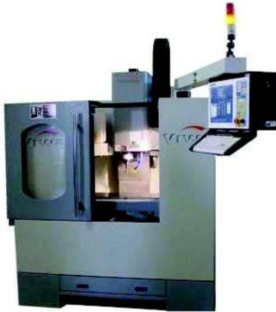
Figura 2.7. Centro de mecanizado VCM3-M400 de la empresa VIWA
