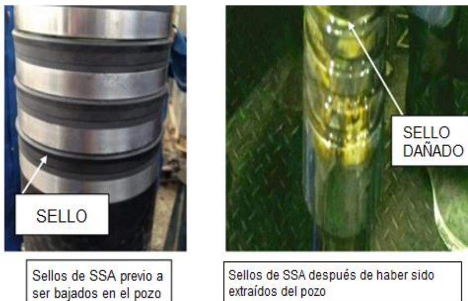
Figura 1. 19. Daño presentado en los sellos Standard pozo Kuwait. Fuente: (Bouhanna, Al-Shammari, AL-Fadli, Mali, & AL-Jasmi, 2014).
