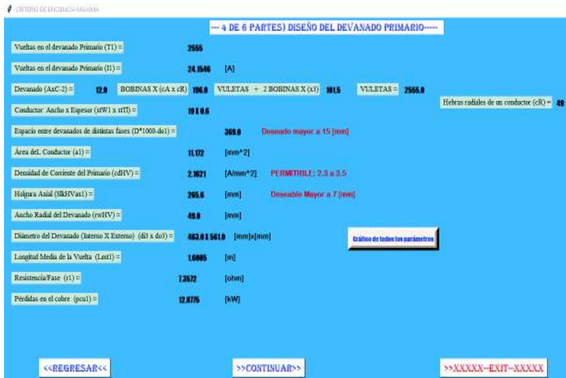
Figura 7.29. Criterio de eficiencia máxima Diseño del devanado de alto voltaje [autoría propia]
