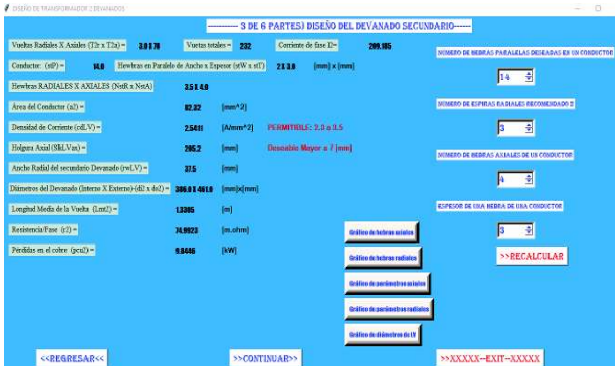
Figura 7.10. Parte 3 diseño del devanado de bajo voltaje [autoría propia]
