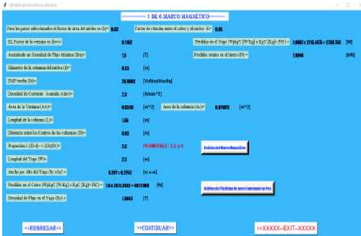
Figura 7.26. Criterio de eficiencia máxima diseño del núcleo magnético [autoría propia]
