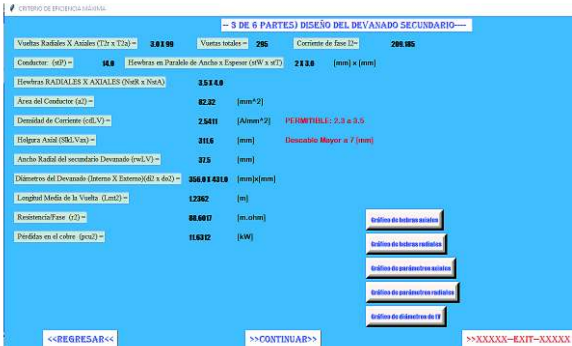
Figura 7.28. Criterio de eficiencia máxima Diseño del devanado de bajo voltaje [autoría propia]
