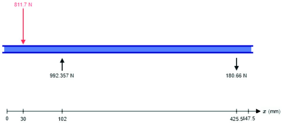
Figura 3.16. Reacciones en el plano XY (descascaradora). (Fuente: Propia)
