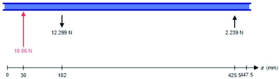
Figura 3.19. Reacciones en el plano XY (descascaradora).
