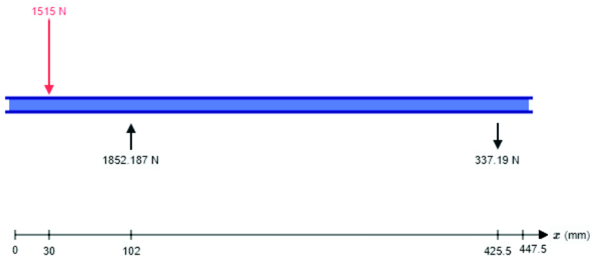
Figura 3.15. Reacciones en el plano XY (descapsuladora).
