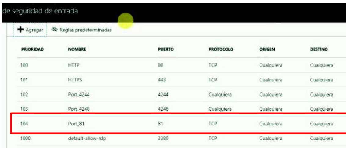
Figura 2.22. Reglas de acceso a la máquina virtual en el portal de Azure
