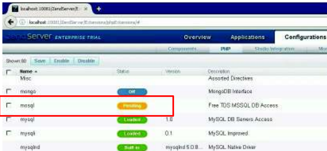
Figura 2.21. Habilitación de la extensión de PHP para SQL en la consola del servidor web
