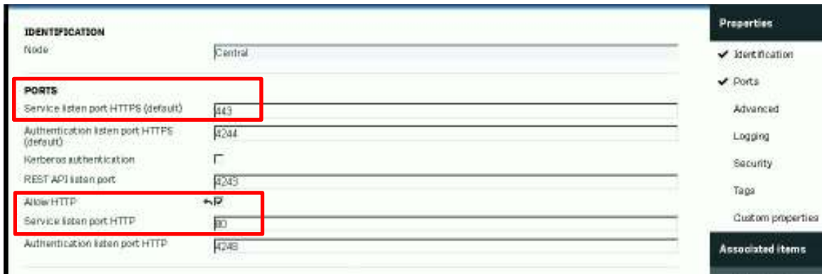
Figura 2.26. Configuración de puertos de acceso para el CMI
