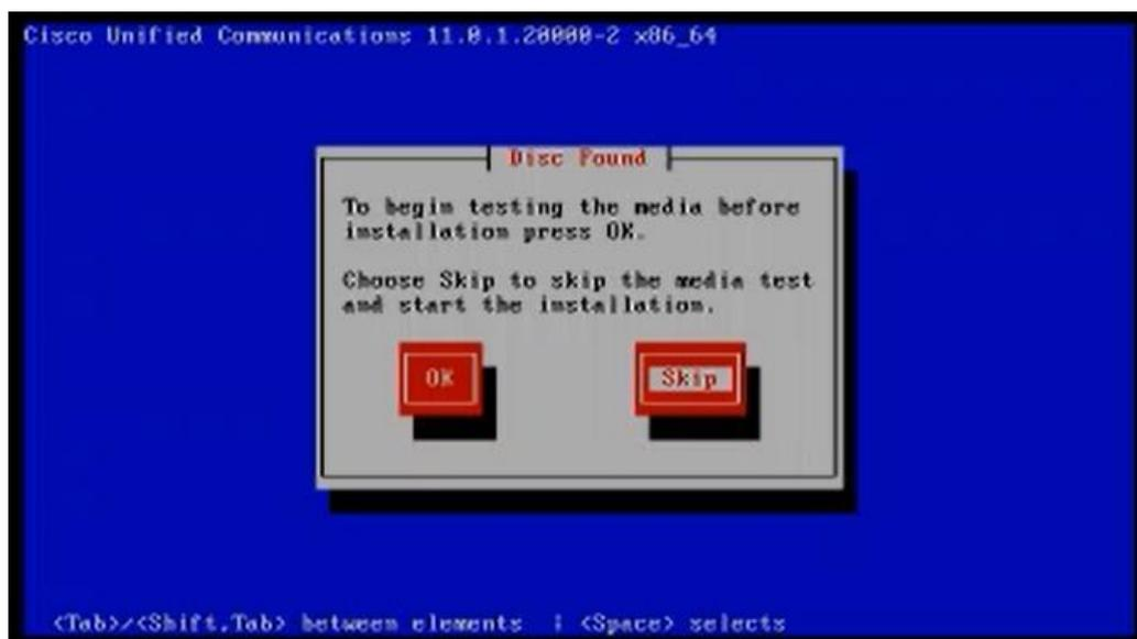
Figura I-36 Validación de la imagen de instalación.
