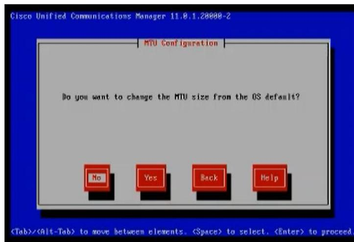
Figura I-45 Configuración de MTU.
