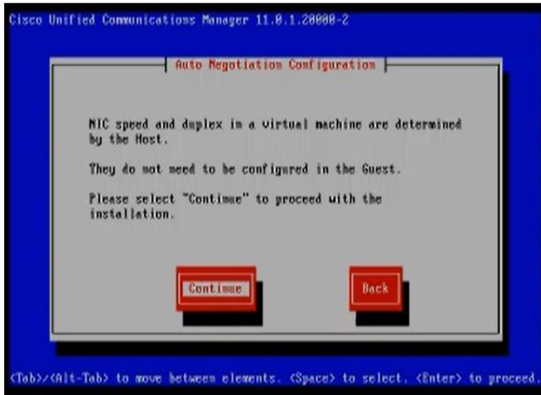
Figura I-44 Confirmación de negociación de tarjeta de red.
