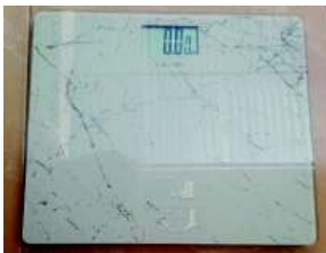
Figura 2.4. Balanza, apreciación 0,5 kg. (Fuente: propia).
