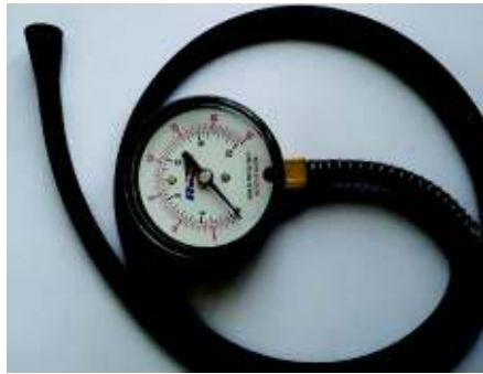
Figura 2.8. Manómetro externo de tercera etapa, apreciación 0,5 pulgH 2 O. (Fuente: propia).
