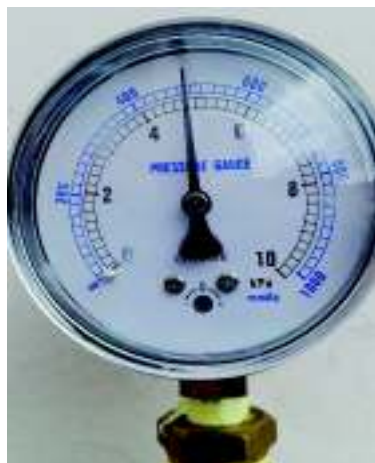
Figura 2.7. Manómetro de Segunda etapa, apreciación 20 mmac. (Fuente: propia).
