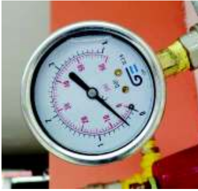
Figura 2.5. Manómetro de Primera etapa, apreciación 1 psi. (Fuente: propia).
