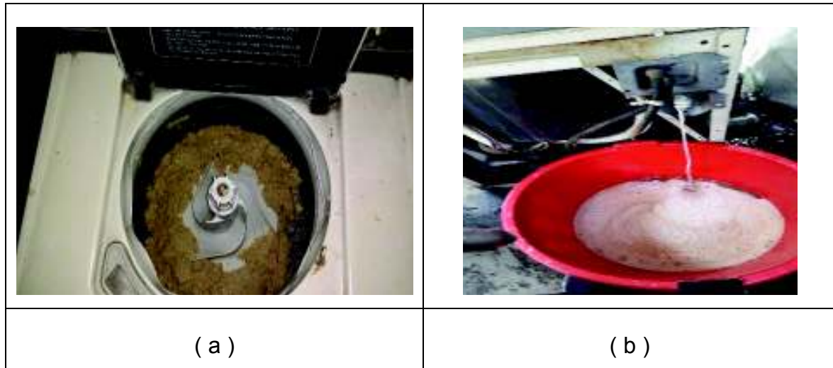
Figura 38. Proceso de tamizado del fruto del maduro: (a) colocación de la muestra fermentada dentro de la centrifugadora; (b) obtención del líquido fermentado para proceder con la destilación.
