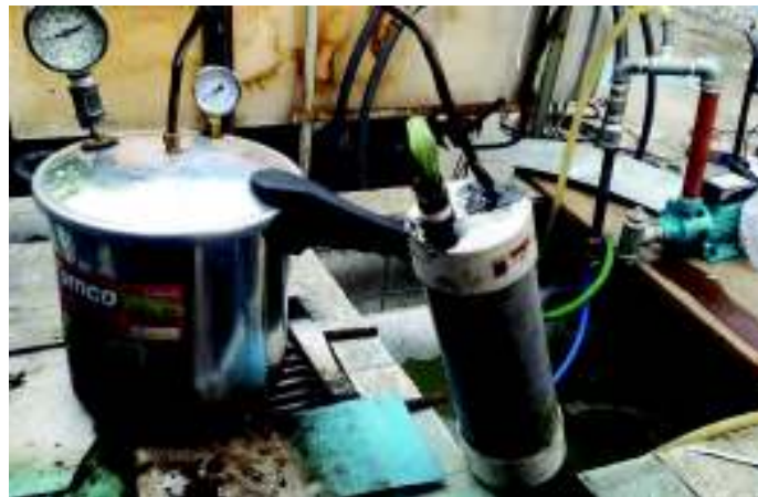
Figura 40. Equipo de destilación casera que se empleó para la obtención de etanol.
