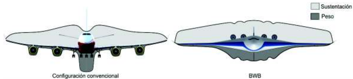
Figura 1.16. Distribución de peso y sustentación en aeronaves. (Fuente: [37])
