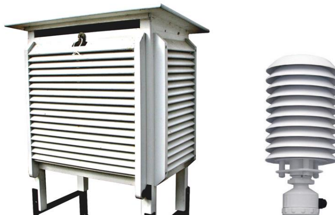
Figura 1.2. Pantalla de Stevenson de madera y pantalla de radiación de ventilación natural cilíndrica [6] [7].
