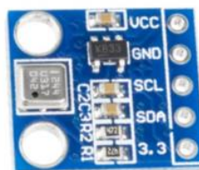
Figura 2.6. Distribución de pines del sensor BMP-180
