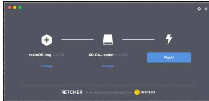
Figura 2.9. Instalación de la imagen del sistema operativo usando Etcher
