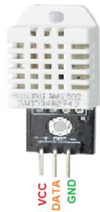
Figura 2.4. Distribución de pines del sensor DHT-22
