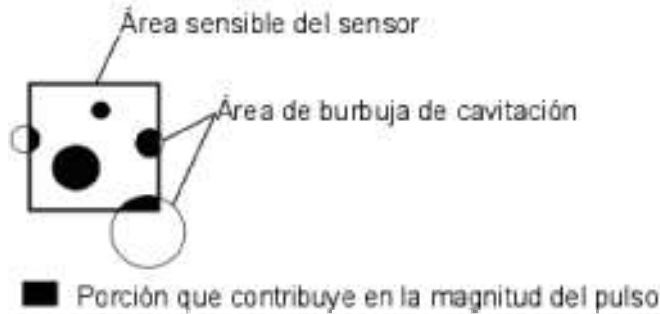
Figura 2.9. Relación entre tamaño del transductor y tamaño de la burbuja que colapsa. (Fuente: [22])
