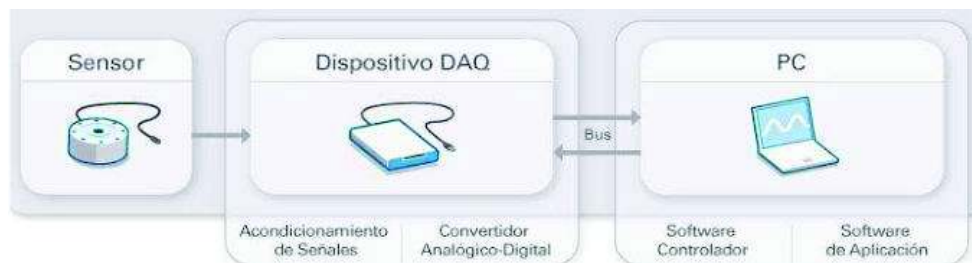
Figura 2.30. Proceso de adquisición de datos. (Fuente: [46])
