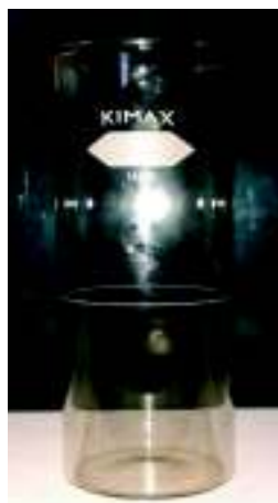
Recipiente de prueba: tubo de vidrio, fondo plano
