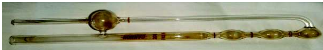
Viscosímetro, capilar de vidrio CANNON 200 748E
