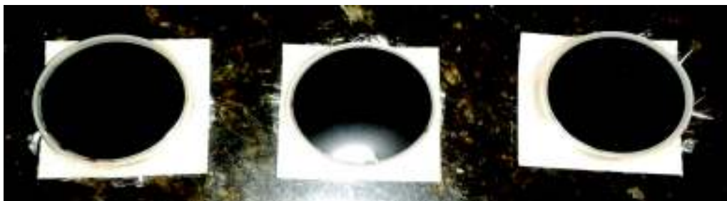
Celdas con crudo lista para introducir en el equipo de medición
