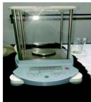
Balanza analítica, con +/- 0.0001 g
