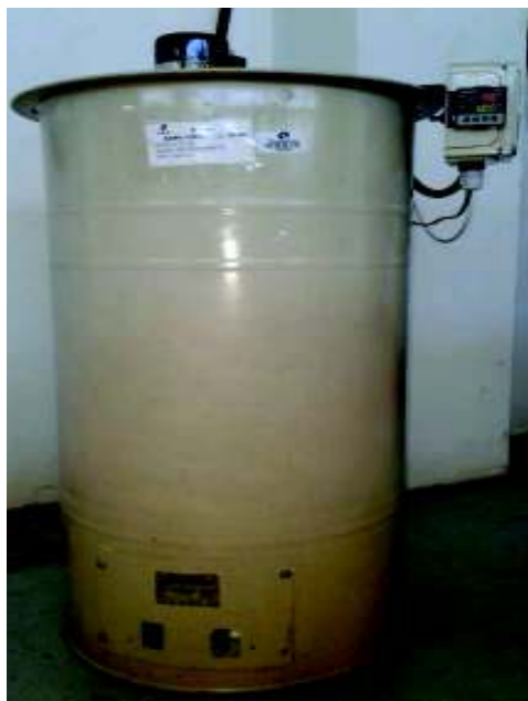
Baño de agua a una temperatura de 37,8 \pm 0,1 \text{ }^\circ\text{C} ( 100 \pm 0,2 \text{ }^\circ\text{F} )
