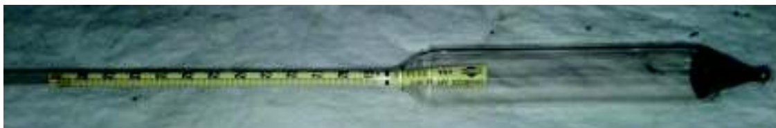
Hidrómetro 3H de vidrio graduado en °API
