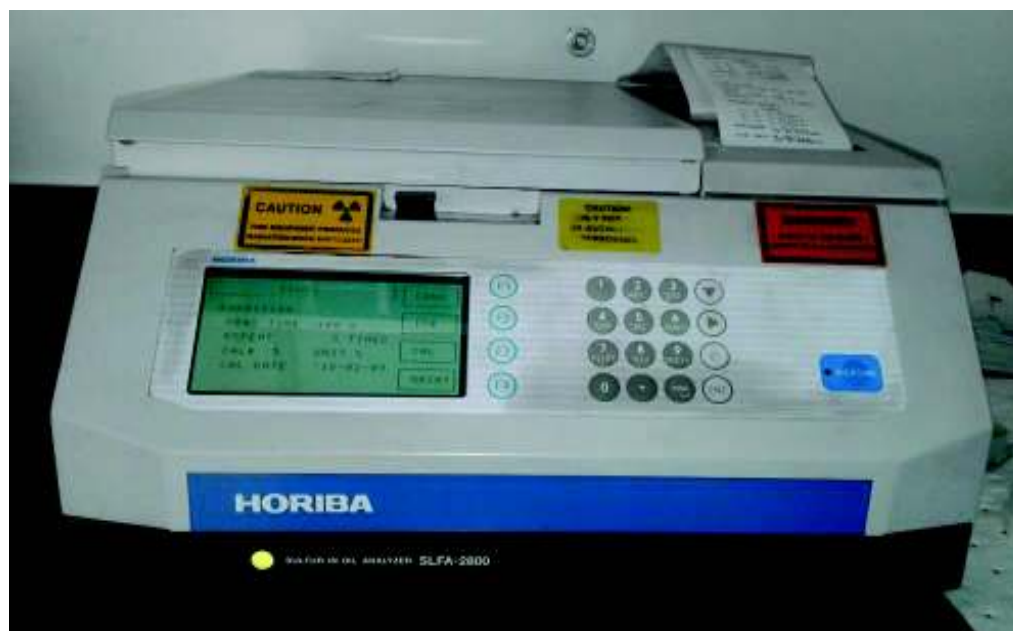
Analizador de energía dispersiva de fluorescencia de rayos X
