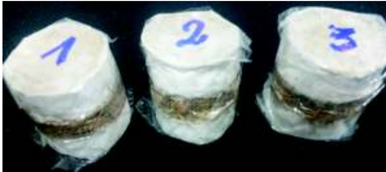
Figura 3.21. Muestras de panel tipo 2 con núcleo de 15 mm.
