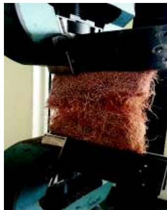
Figura 2.19. Ensayo de esfuerzo último de tracción para no tejido de fibra de coco.
