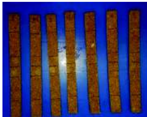
Figura 1. Probetas ensayadas a tracción de tableros con 20% de UF y 1,88 MPa de presión.
