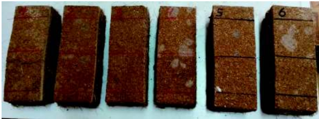
Figura 3.6. Muestras de panel tipo 1 (45 mm de núcleo) previo al ensayo.
