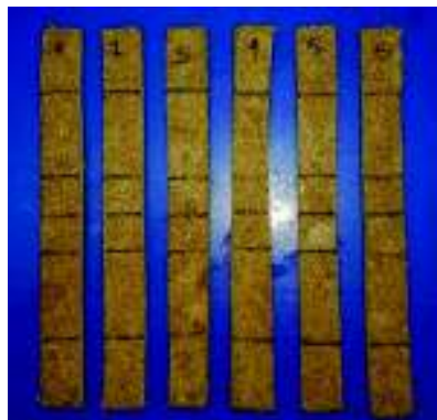
Figura 7. Probetas ensayadas a tracción de tableros con 30% de UF y 2,82 MPa de presión.
