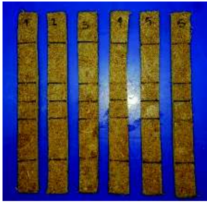
Figura 3.1. Probetas ensayadas a tracción de tableros con 30 % de UF y 2,82 MPa de presión.
