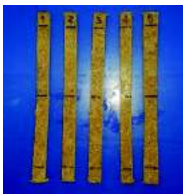
Figura 8. Probetas ensayadas a flexión de tableros con 30% de UF y 2,82 MPa de presión.
