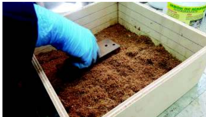
Figura 2.8. Moldeo manual de la mezcla polvillo de coco y urea UF.
