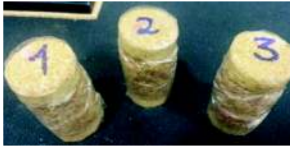
Figura 3.19. Muestras de panel tipo 1 con núcleo de 45 mm.
