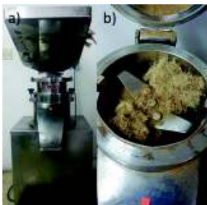
Figura 2.2. Molino de cuchillas. a) Vista Externa, b) Vista interna, cuchillas.
