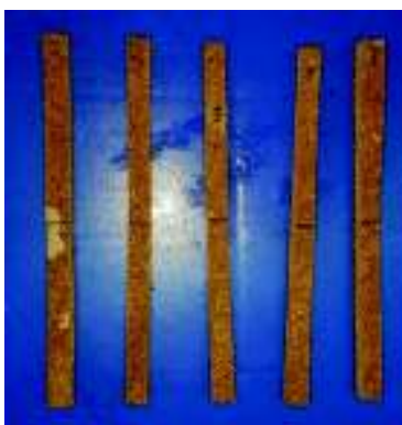
Figura 2. Probetas ensayadas a flexión de tableros con 20% de UF y 1,88 MPa de presión.
