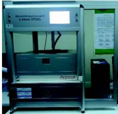
Figura 2.21. Medidor de conductividad térmica de placa caliente, Lambda-Messtechnik, modelo \lambda -Meter EP500e, Versión C.
