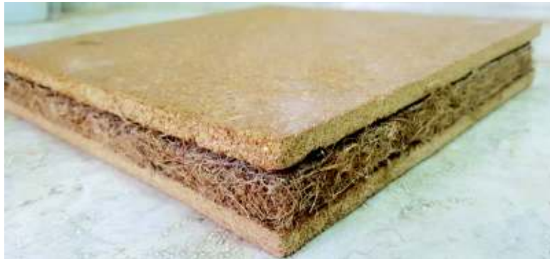
Figura 2.13. Conformación de panel sánduche tipo 1, constituido por tableros de coco y núcleo de no tejido de fibra de la misma naturaleza.
