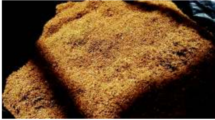
Figura 2.5. Polvillo grueso de coco, tamices normalizados ASTM E11 No.10 y No.30. (Fuente: Propia)
