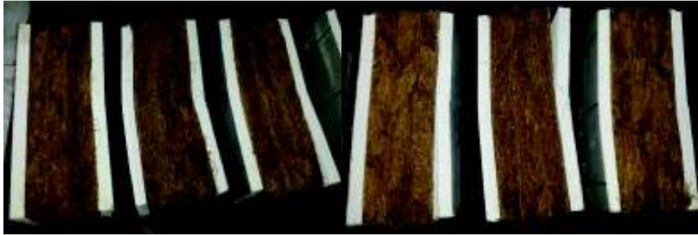
Figura 3.9. A) Muestras de panel tipo 2 (45 mm de núcleo) ensayadas. B) Fractura.
