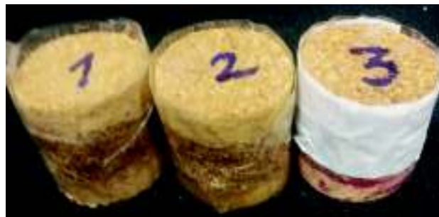
Figura 3.17. Muestras de panel tipo 1 con núcleo de 15 mm.
