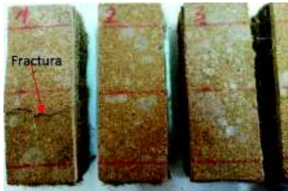
Figura 3.7. Muestras de panel tipo 1 (45 mm de núcleo) ensayadas, se aprecia fisura.
