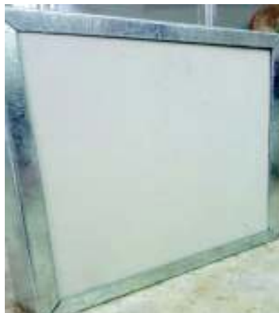
Figura 2.15. Panel sánduche tipo 2 con soporte metálico.
