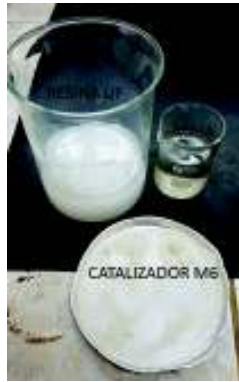
Figura 2.7. Componentes de la resina UF empleada en el moldeo.
