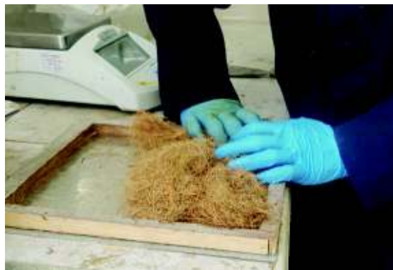
Figura 2.10. Moldeo manual de no tejido de coco.
