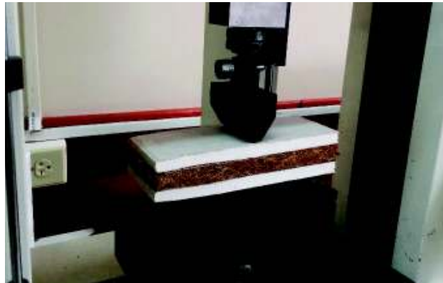
Figura 2.20. Ensayo de flexión a tres puntos para panel sánduche tipo 2 con núcleo de 15 mm.
