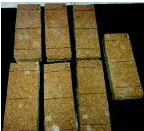
Figura 3.5. Muestras de panel tipo 1 (15 mm de núcleo) ensayadas.
