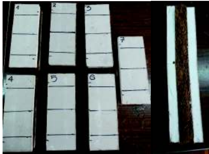
Figura 3.8. a) Muestras de panel tipo 2 (15 mm de núcleo) ensayadas. b) Fractura en cara perpendicular a la carga.
