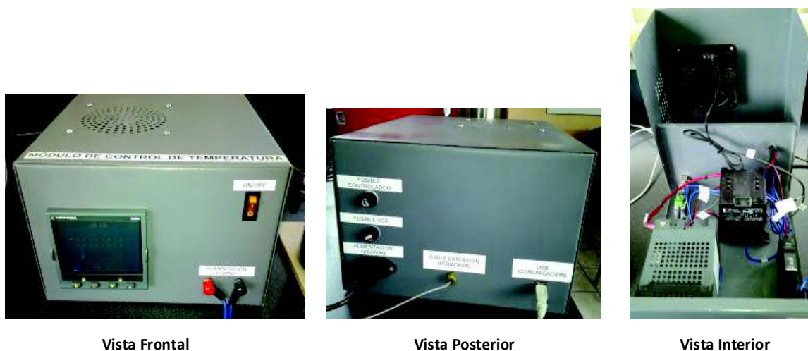
Figura 2.5. Módulo de Control de Temperatura (diseño actual).
