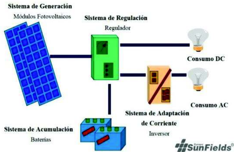
Figura 3. Sistema fotovoltaico autónomo [11]
