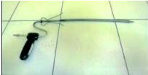
Figura 1.22. Sonda para gases de combustión.
