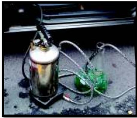
Figura 1.19. Tanque de presión de combustible (Canister).
