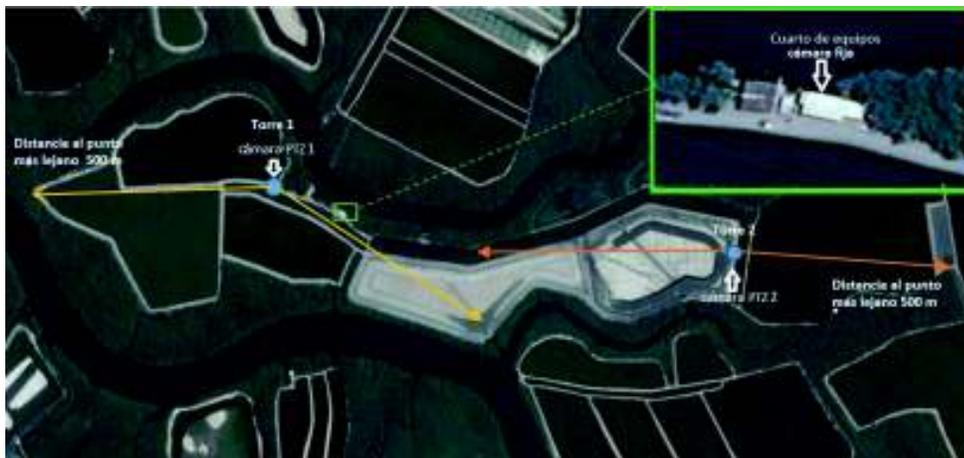
**Figura 2.28** Ubicación de la cámara fija, cámaras PTZ y distancias de visión a los puntos más lejanos
