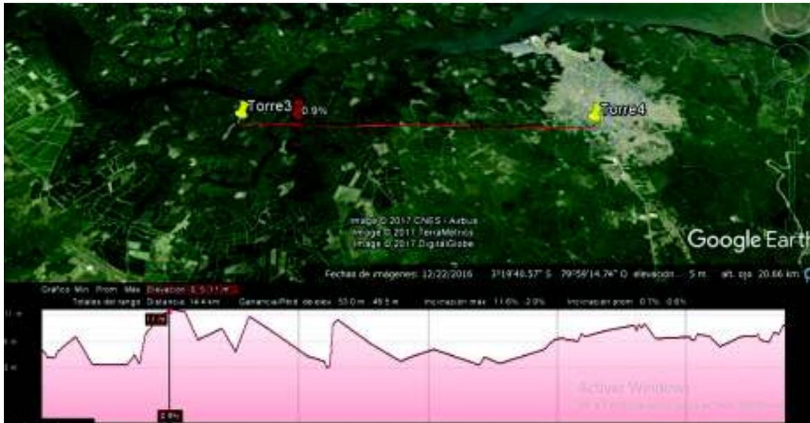
**Figura 2.32** Perfil topográfico del enlace troncal
