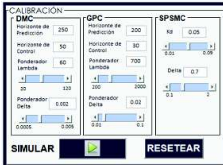
Figura III.5. Módulo de calibración de controladores.
