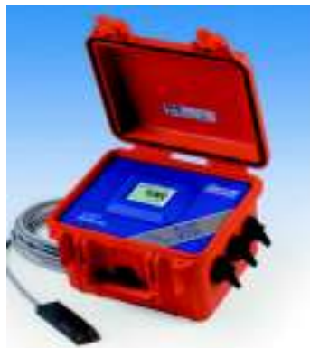
Figura 2.2. Sensor ultrasónico de tipo clamp-on para las turbinas.
