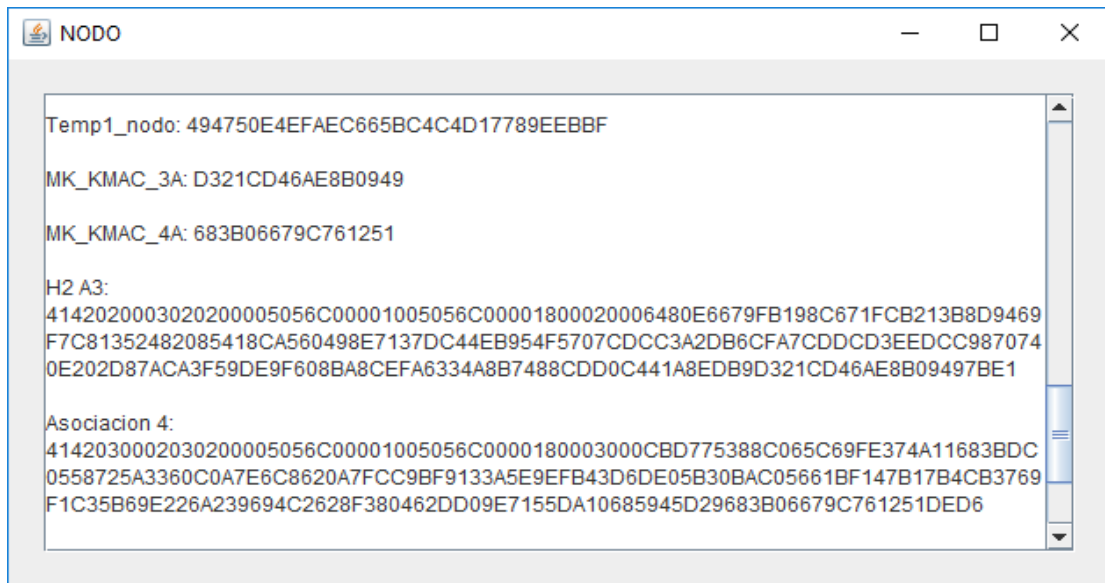
Figura 3.13. Creación de elementos de autenticación en el Nodo.
