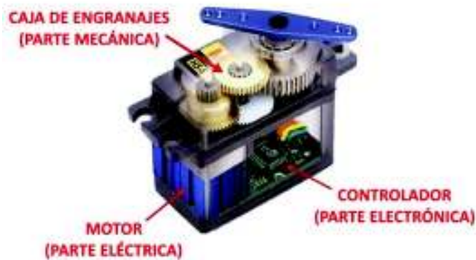
Figura 1.10: Componentes de un servomotor [20].
