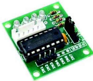
Figura 3.3: Driver ULN2003 para controlar un motor a pasos unipolar [19].
