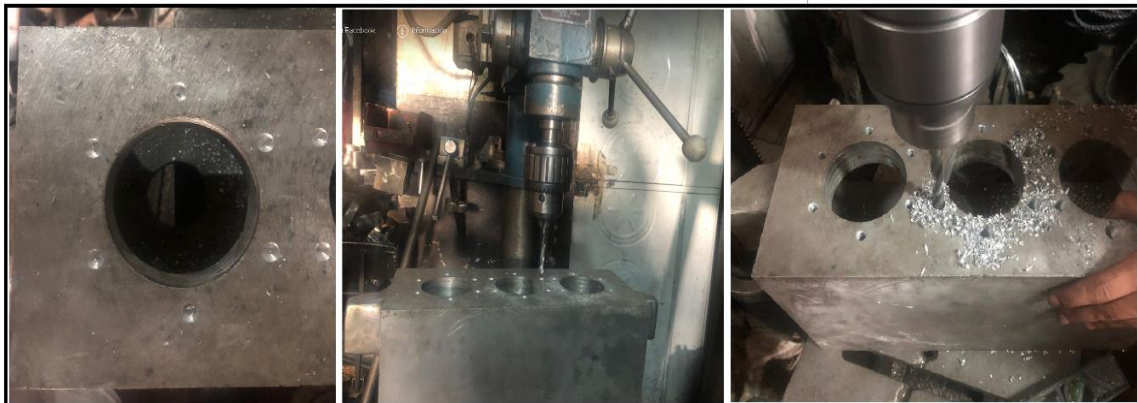
Figura 2.12. Mecanizado con ayuda de acople de cámaras/separador. (Fuente propia)
