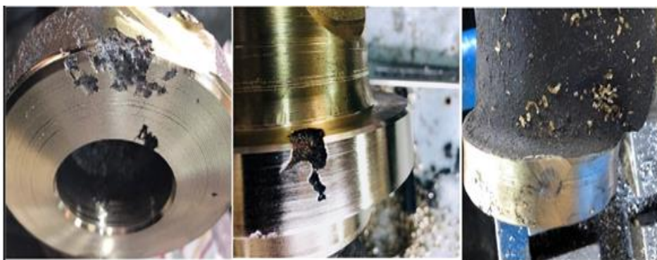
Figura 3.3. Defectos de fundición en la cámara.
