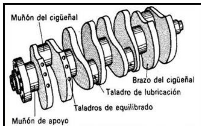
Figura 1.11. Partes del cigüeñal. (Millares de Imperial & Villalta E., 2000, pág. 145)
