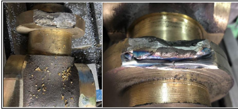
Figura 3.4. Defecto de fundición, Incrustación en cámara. (Fuente propia)
