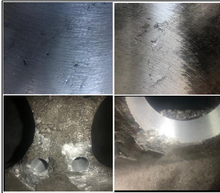
Figura 3.14. Defectos de fundición en el separador.
