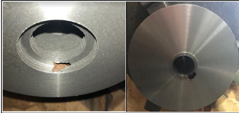
Figura 3.9. Defectos de las tapas laterales. (Fuente propia)
