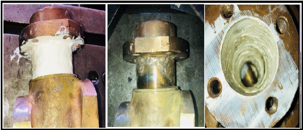
Figura 3.26. Reparación de defectos de cámaras.
