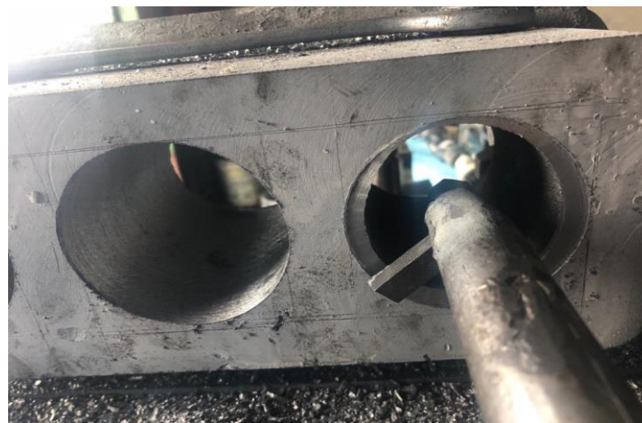
Figura 3.11. falla de fundición en carcasa (disposición de cilindros).
