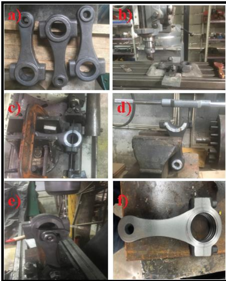
Figura 2.21. Mecanizado de biela: a) bielas fundidas b) Planeado de caras, c) Corte de cabeza de biela con sierra de cinta, d) Roscado, e) Perforado, f) Biela termina. (Fuente propia)
