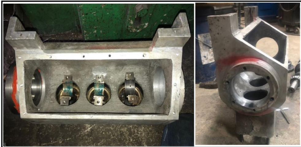
Figura 3.13. Carcasa terminada. (Fuente propia)
