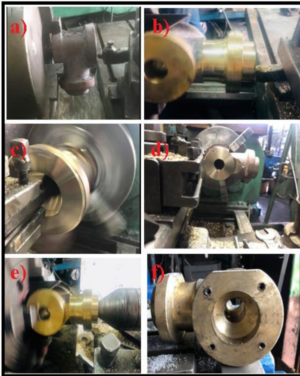
Figura 2.29. Mecanizado de cámara: a) Refrentado cara de succión b) Refrentado prensa estopa, c) Cilindrado interior, d) Cilindrado exterior, e) Torneado exterior, f) Biela termina. (Fuente propia)
