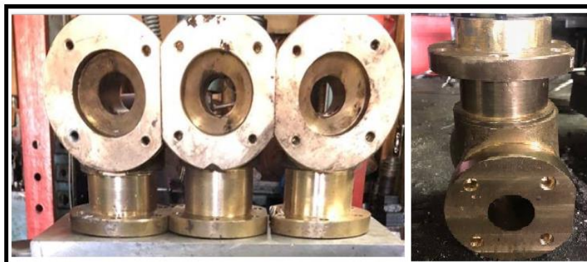
Figura 18. Cámara Terminada. (Fuente propia)
