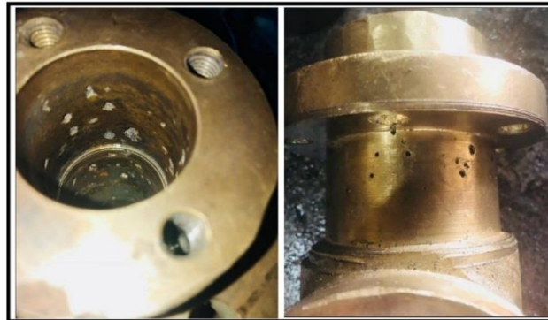
Figura 3.5. Defecto de fundición, Porosidades. (Fuente propia)
