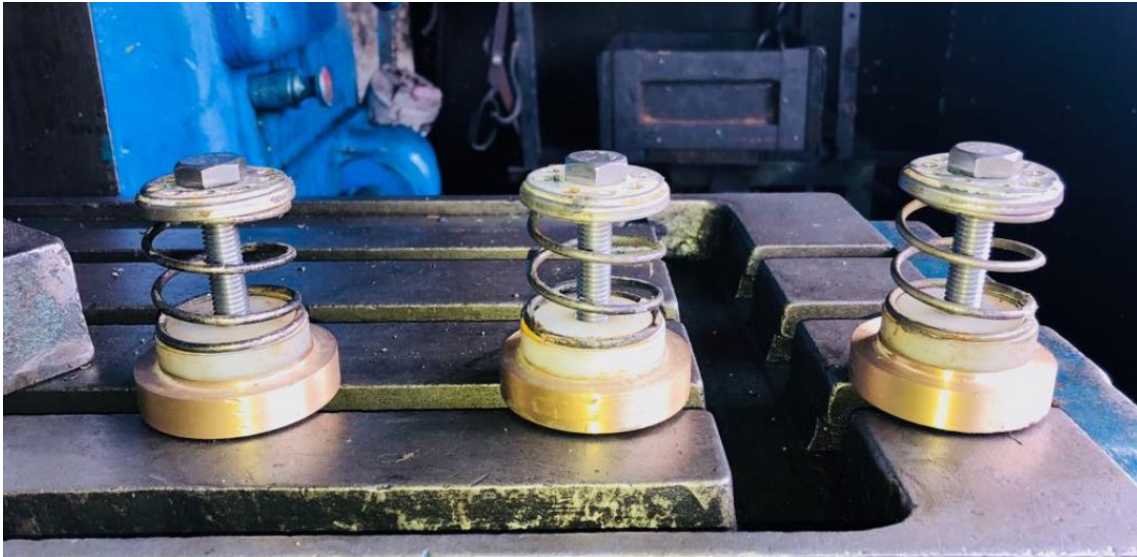
Figura 3.22. Válvulas de descarga. (Fuente propia)
