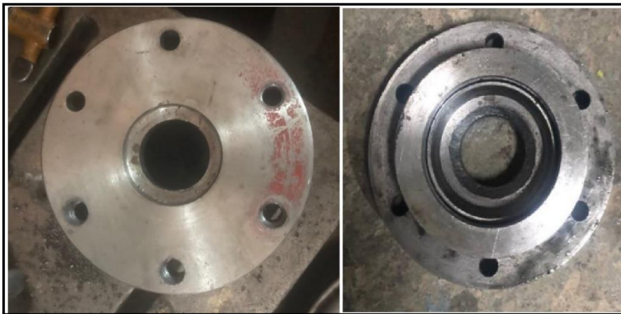
Figura 3.10. tapa lateral terminada. (Fuente propia)
