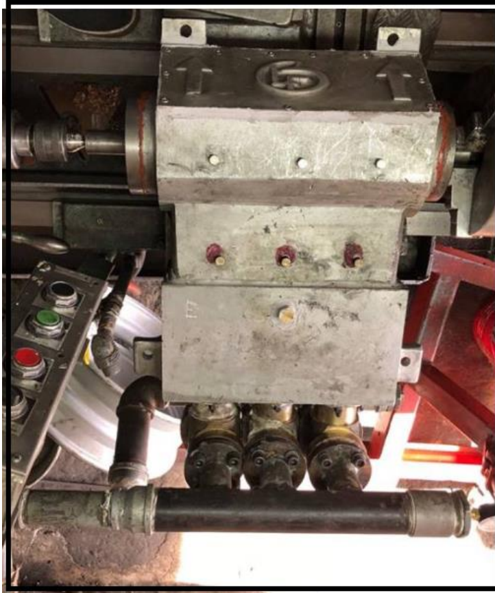
Figura 2.45. Bomba triplex vista frontal. (Fuente propia)
