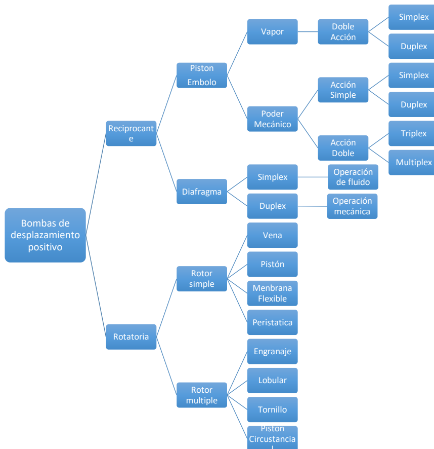
Figura 1.5. Clasificación de las bombas de desplazamiento positivo.
