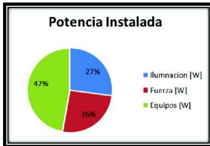
Figura 3.10 Porcentaje de la Potencia Instalada.
