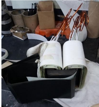
Figura 4.15. Ensamble de las bobinas al núcleo
