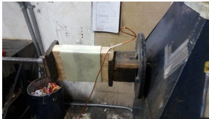
Figura 4.9. Bobinado de los devanados de alto y bajo voltaje
