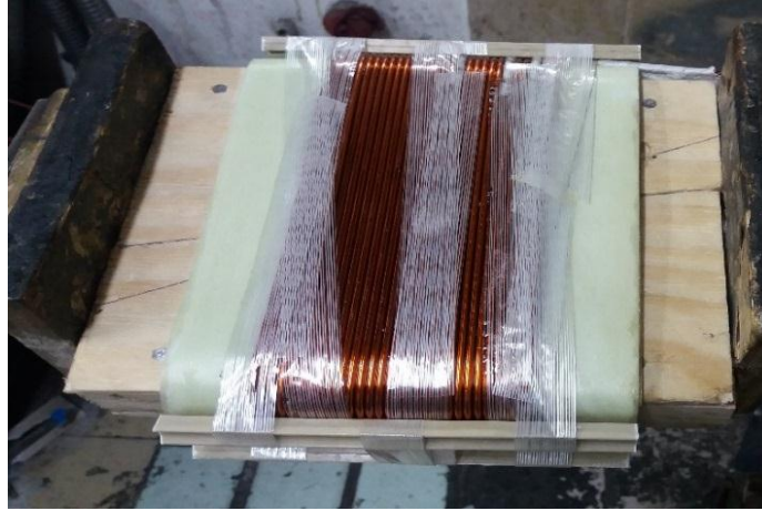
Figura 4.12. Aislamiento entre las bobinas de alto y bajo voltaje
