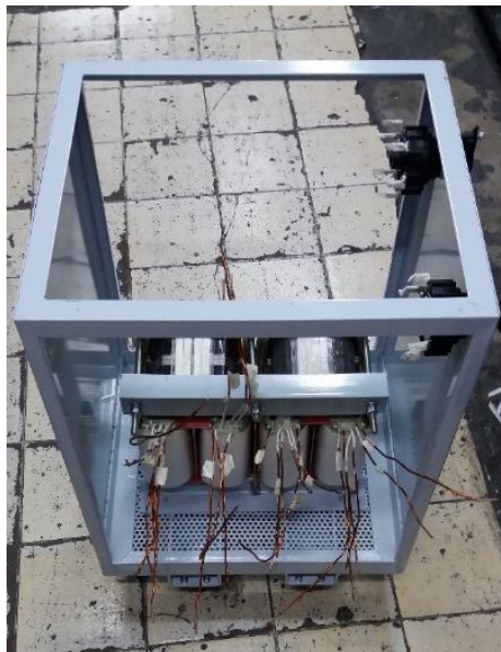
Figura 4.18. Transformador prensado y montado en el tanque
