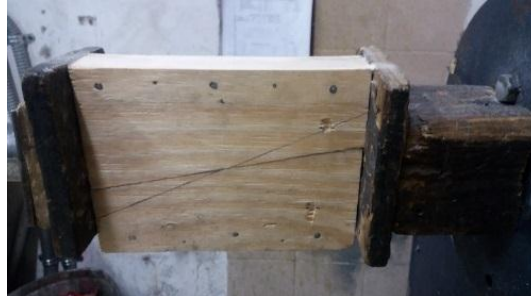
Figura 4.8. Montaje de la formaleta para la construcción de las bobinas
