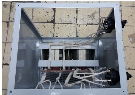
Figura 4.20. Sujeción de los taps al conmutador
