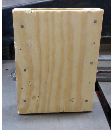
Figura 4.7. Formaleta para la construcción de las bobinas
