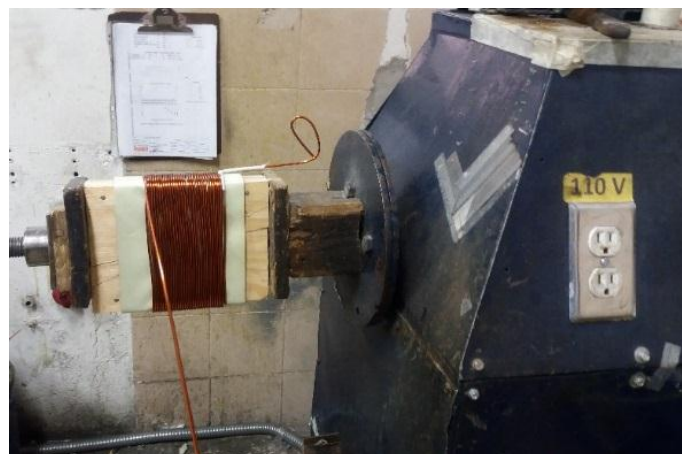
Figura 4.10. Primera capa del bobinado de las bobinas
