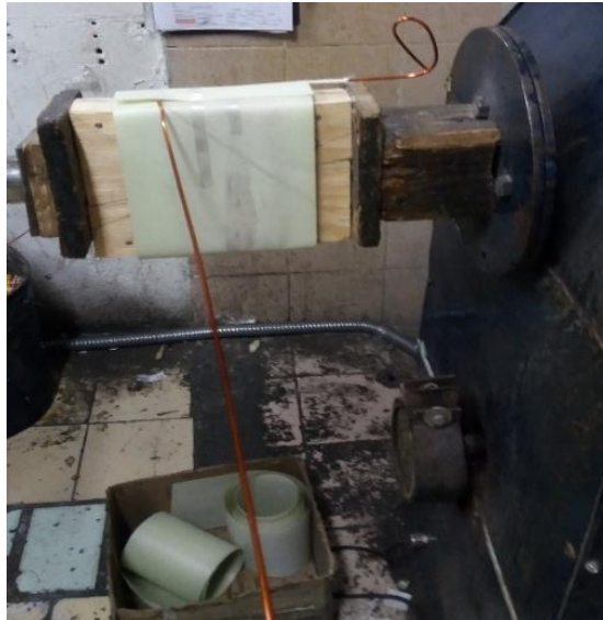
Figura 4.11. Aislamiento de la primera capa
