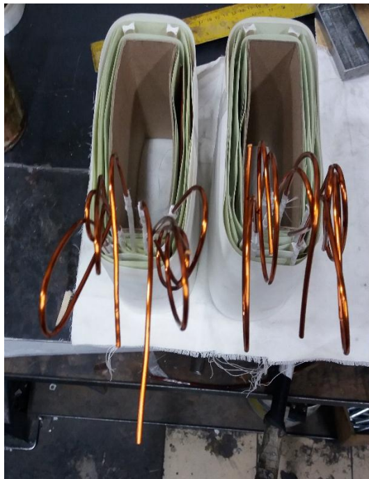
Figura 4.14. Bobinas terminadas y horneadas
