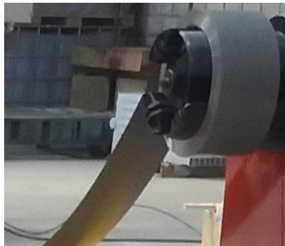
Figura 4.1. Acero al silicio de grado M-4 [20]
