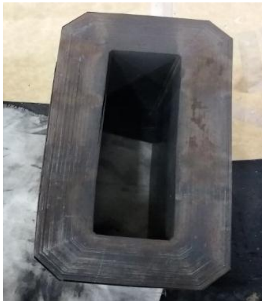
Figura 4.4. Presentación del núcleo arrollado ordenado por bloques y de forma escalonada
