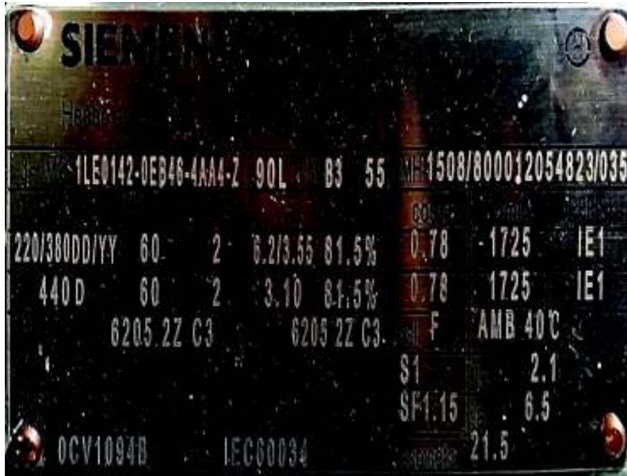
Figura 2.1. Datos de placa del motor de prueba
