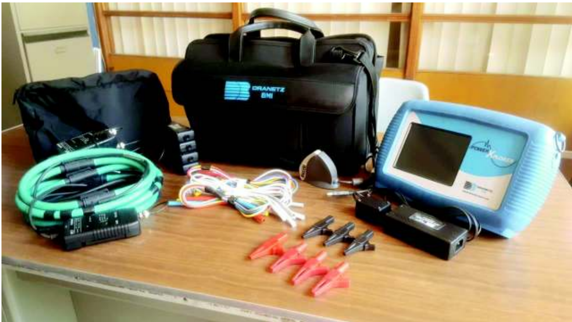
Figura 1.4. Analizador de red PowerXplorer PX5-Dranetz
