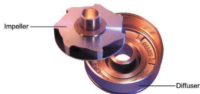
Figura 1.10. Fotografía de una etapa de bomba centrífuga. (Fuente: (Centrilift, B. H., 2008))
