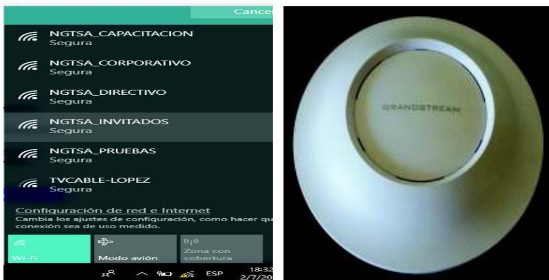
Figura 3.22. Punto de acceso GWN 7610 y sus redes configuradas
