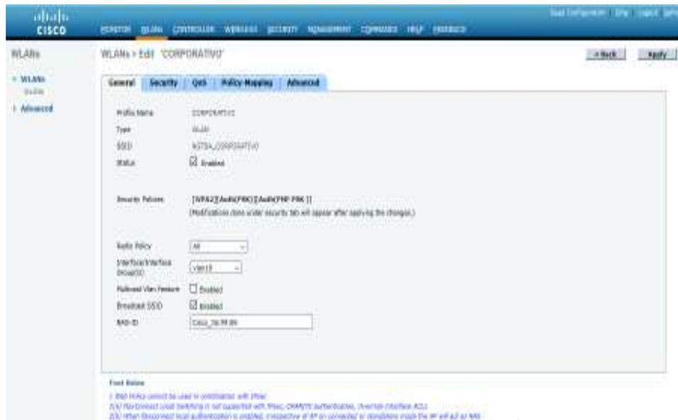
**Figura 3.32.** Configuración de seguridad red Corporativa en la controladora Cisco
