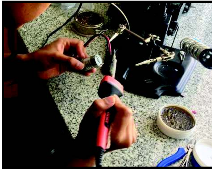
Figura 3.21 Cables soldados a motores
