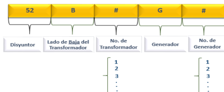
Figura 3.6: Nomenclatura de los Elementos de las Bahías de Generadores con su respectivo Transformador [Elaboración Propia].
