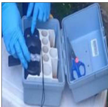
Figura 7. Equipo medidor de cloro residual in situ
