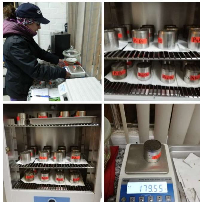
Figura 20. Análisis de densidad aparente en el laboratorio. ELABORADO POR: Cadena y Yáñez
