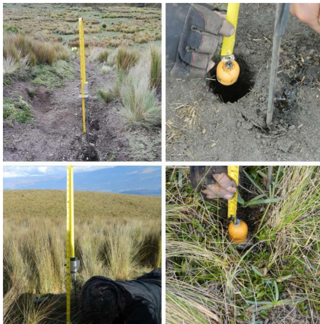
Figura 8. Ensayo de pozo invertido. ELABORADO POR: Cadena y Yáñez
