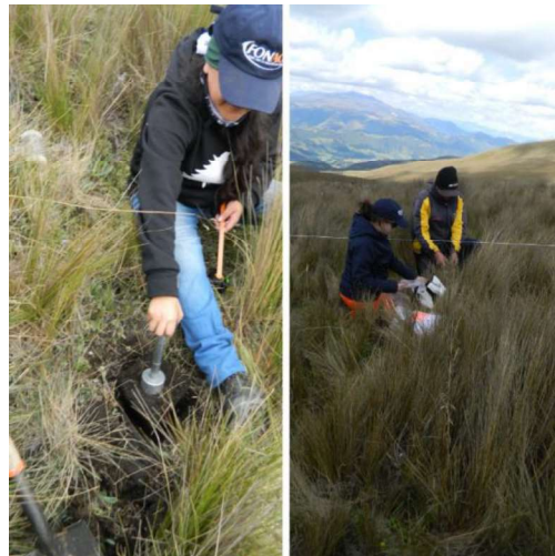
Figura 13. Toma de muestras para densidad aparente ELABORADO POR: Cadena y Yáñez
