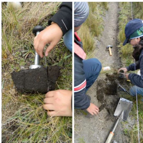
Figura 14. Toma de muestras para densidad aparente ELABORADO POR: Cadena y Yáñez
