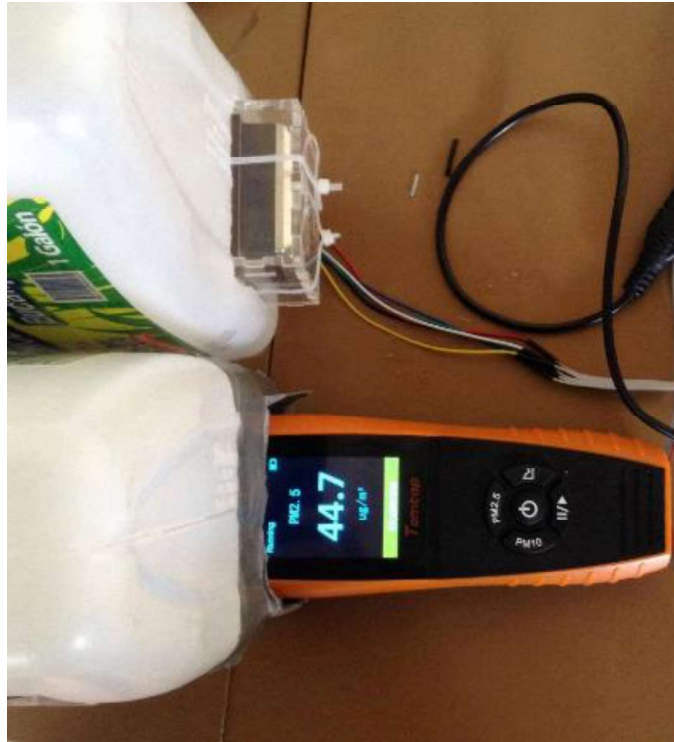
Figura 2.29. Calibración sensor PM2.5
