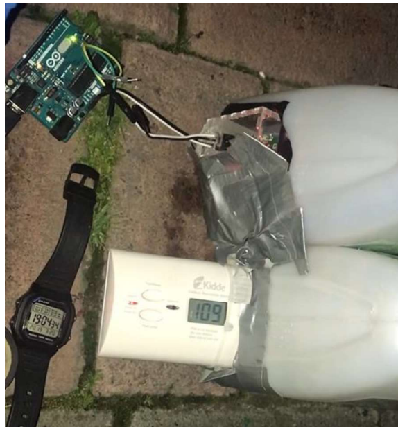
Figura 2.25. Proceso de calibración MQ-7
